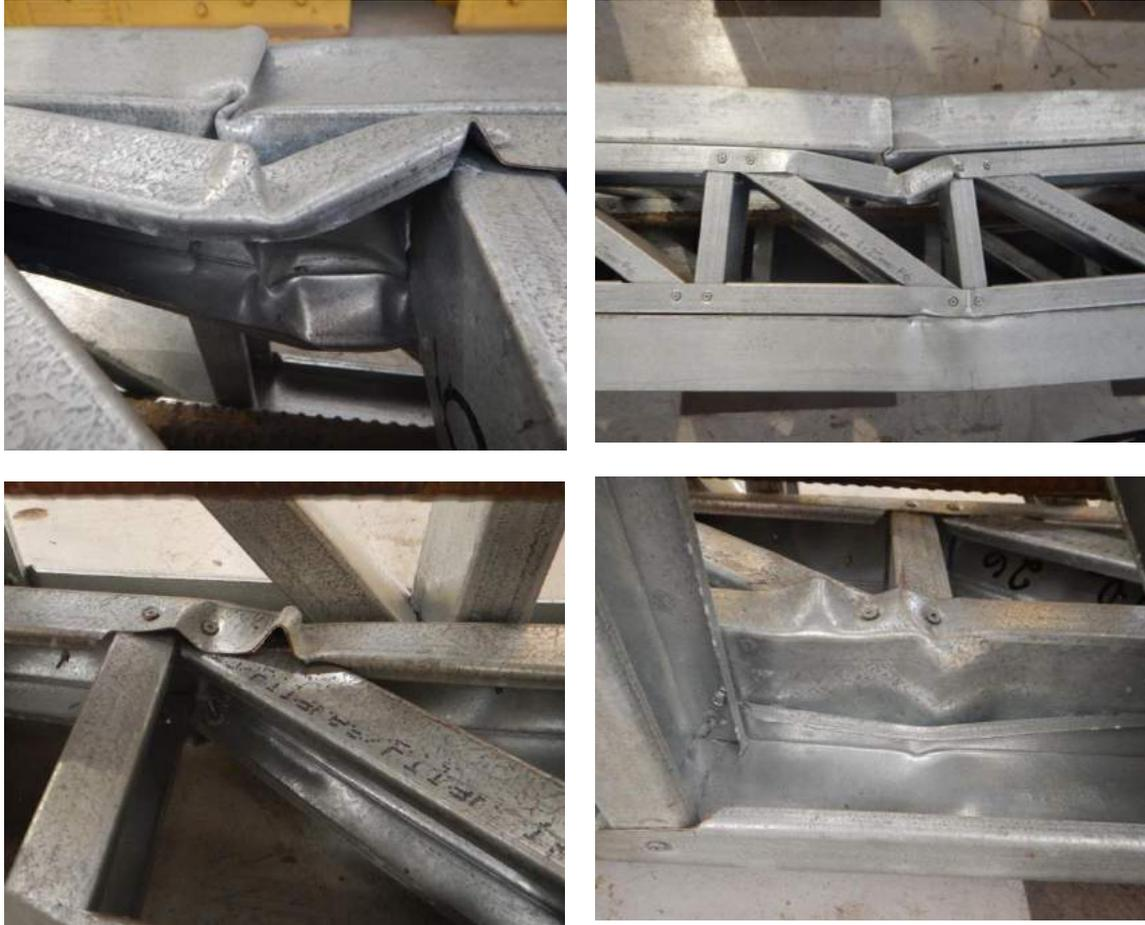
Figura A5.40 Mecanismo de colapso próximo ao meio do vão da coluna treliçada T16x1,25, entre os módulos 22 e 23 da treliça. Carga de colapso de 196kN.
