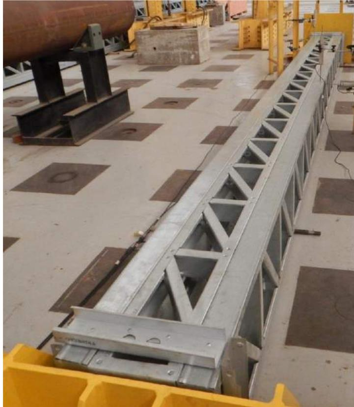
Figura 2.11 Coluna treliçada com 6200mm de comprimento na posição do ensaio.
