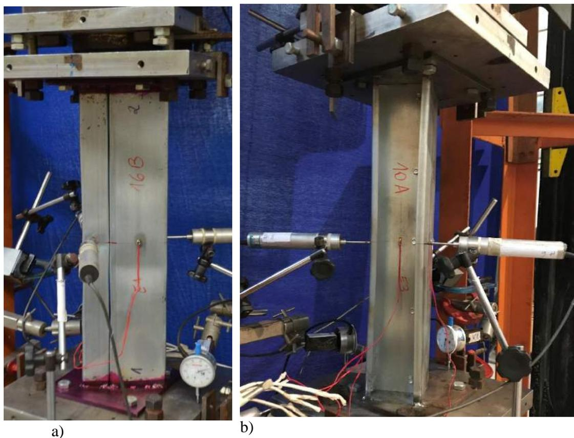
Figura 3.14: Modos de flambagem local e distorcional dos corpos de prova com chapas de extremidade soldadas: a) Corpo de prova M16p3S: flambagem local se desenvolvendo ao longo da alma do membro B com seis semi-ondas; b) Corpo de prova M10p5S: oito semi-ondas de flambagem local na alma combinada com uma onda de flambagem distorcional observadas no membro A.
