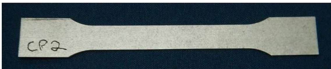
Figura 2.36 Foto do corpo de prova de amostra extraída da treliça após ensaiada.
