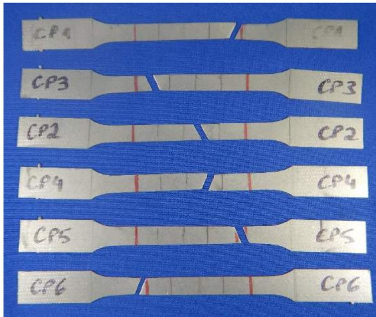
Figura 3.9 Falha característica dos seis corpos de prova nos ensaios de tração direta.
