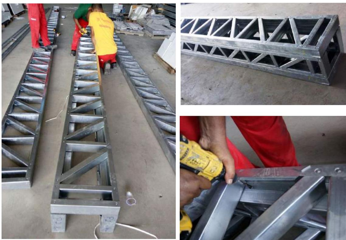
Figura 2.10 (a) Colunas treliçadas com comprimento de 12200mm sendo montadas na fábrica da GypSteel. Após montadas foram transportadas para o LABEST para realização dos ensaios. (b) Exemplo de uma coluna treliçada instalada no galpão da GypSteel em Saquarema
