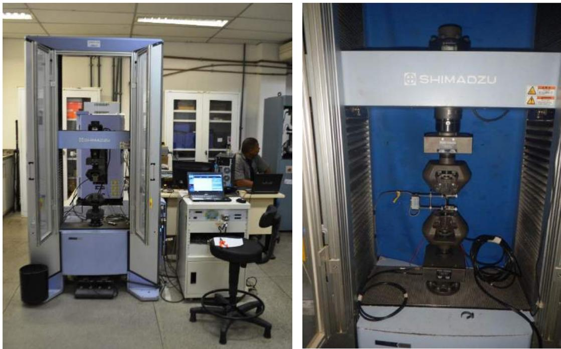
Figura 2.33 Equipamento SHIMADZU utilizado no ensaio de tração do aço.
