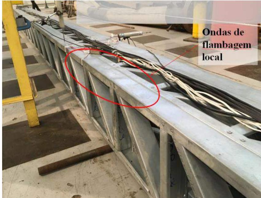
Figura 4.1: Coluna T16x0,8: modo de flambagem local desenvolvido ao longo da alma dos perfis externos durante o teste.
