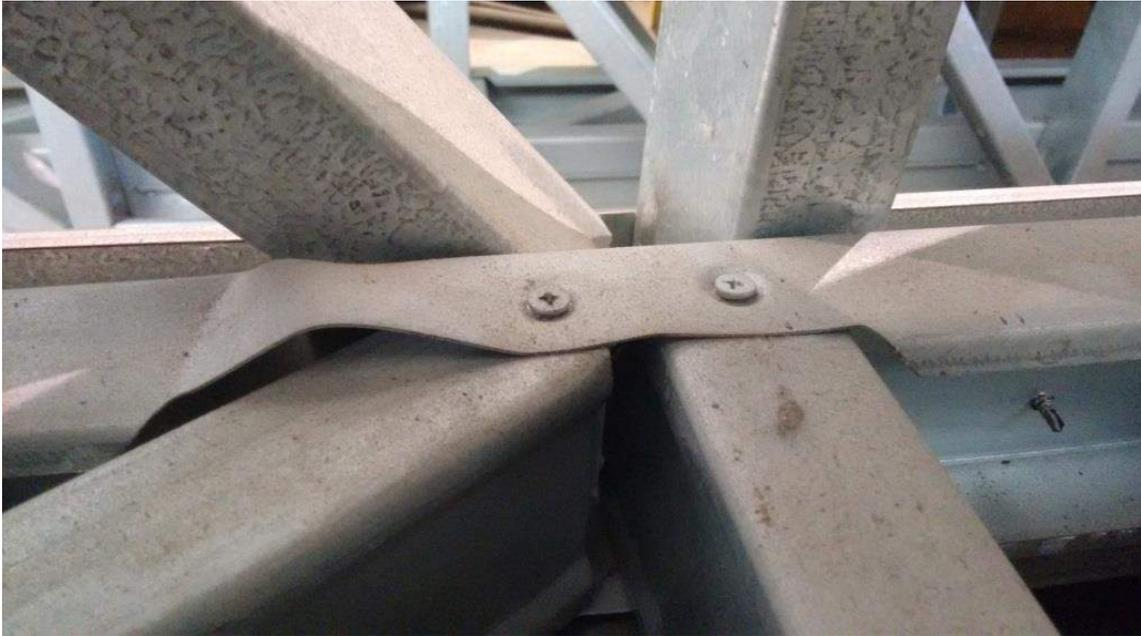
Figura A5.4 Flambagem local no montante interno próximo a extremidade da rótula, onde existe a redução da seção devido a supressão dos enrijecedores de borda .
