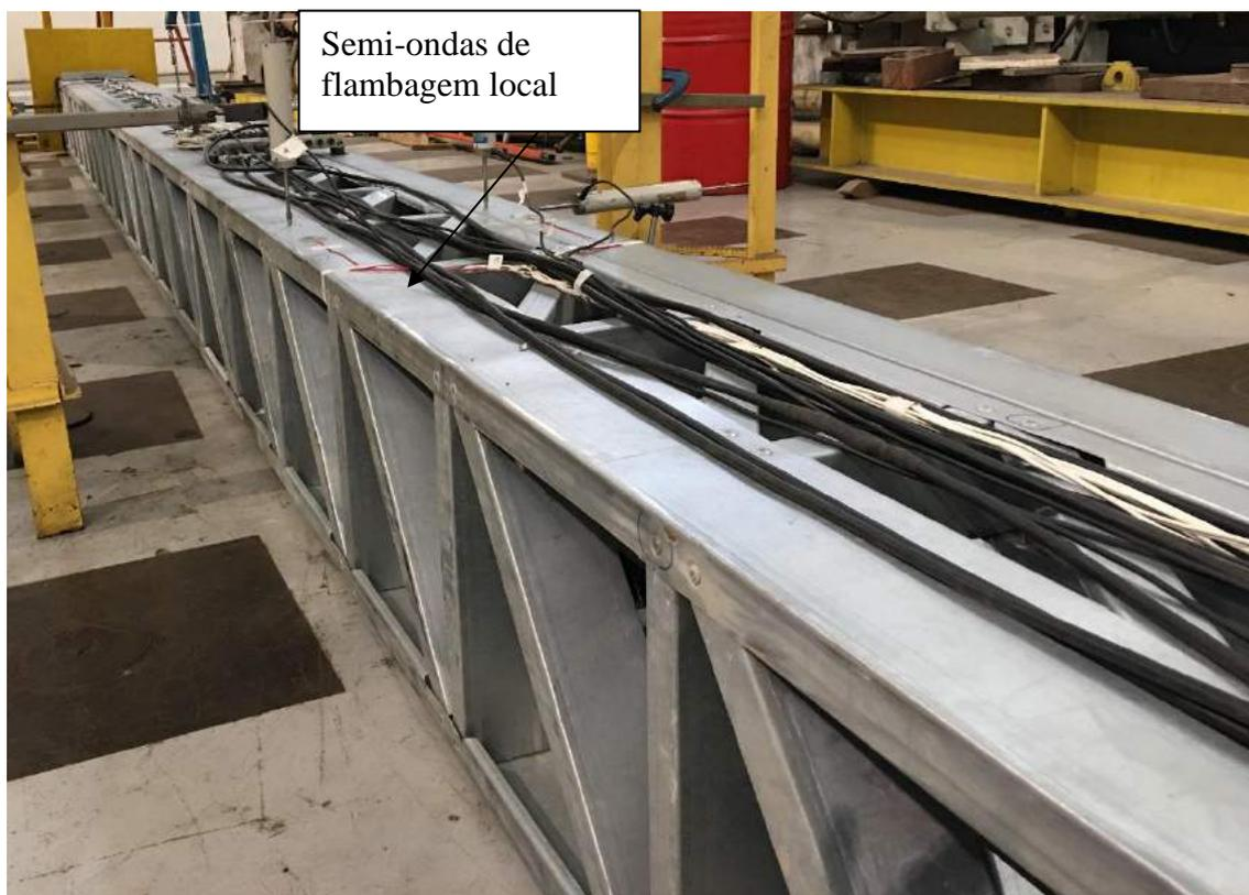
Figura A5.25 Semi-ondas de flambagem local ao longo da alma do montante para a carga de 80kN (próximo ao colapso).
