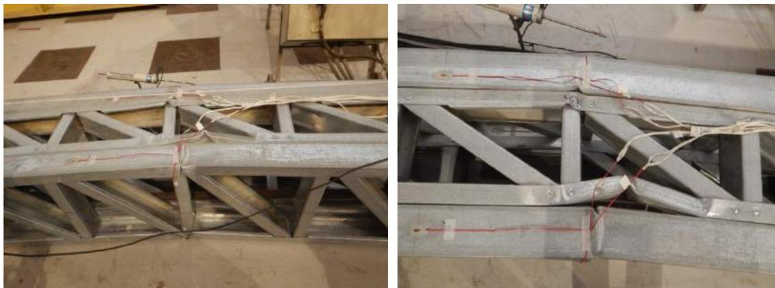
Figura A5.13 Mecanismo de colapso próximo ao meio do vão. Carga máxima de 233kN.
