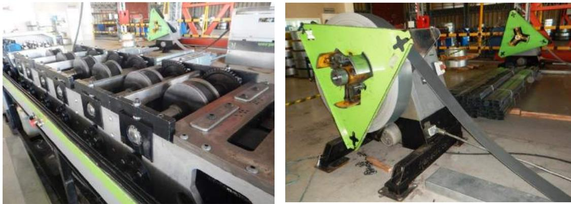
Figura 2.8 Perfiladeira e desenrolador utilizados pela empresa GypSteel para a conformação dos perfis dobrados a frio (GYPSTEEL, 2017).
