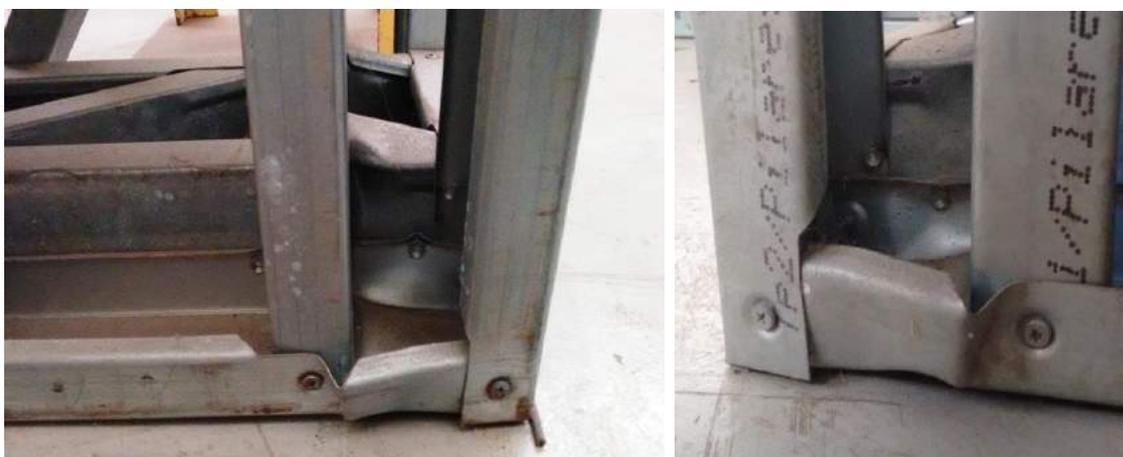
Figura A5.1 Foto do colapso devido ao esmagamento ocorrido na cabeça da coluna treliçada T6x0,8, na extremidade fixa (extremidade do atuador).
