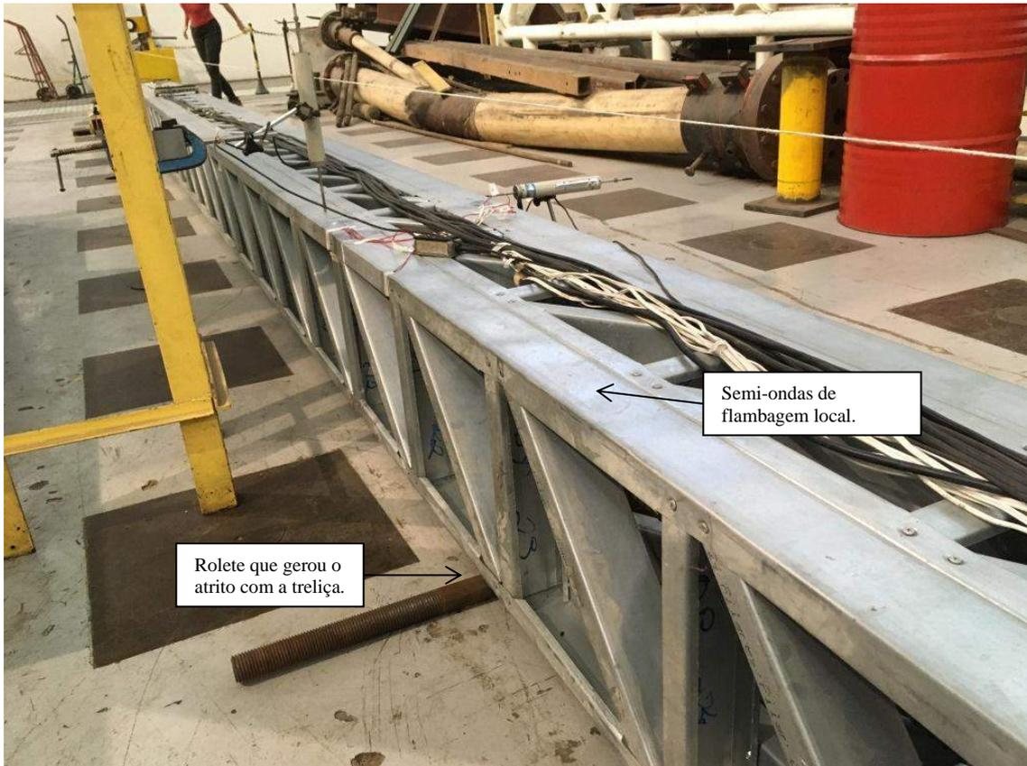
Figura A5.49 Semi-ondas de flambagem local ao longo das almas dos montantes externos para a carga aproximada de 65kN. Rolete posicionado embaixo da treliça.
