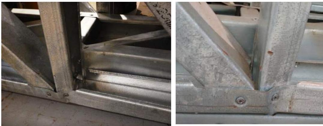
Figura A5.5 Mecanismo de colapso devido à flambagem local no montante externo próximo a extremidade da rótula, na seção onde ocorre a supressão dos enrijecedores.
