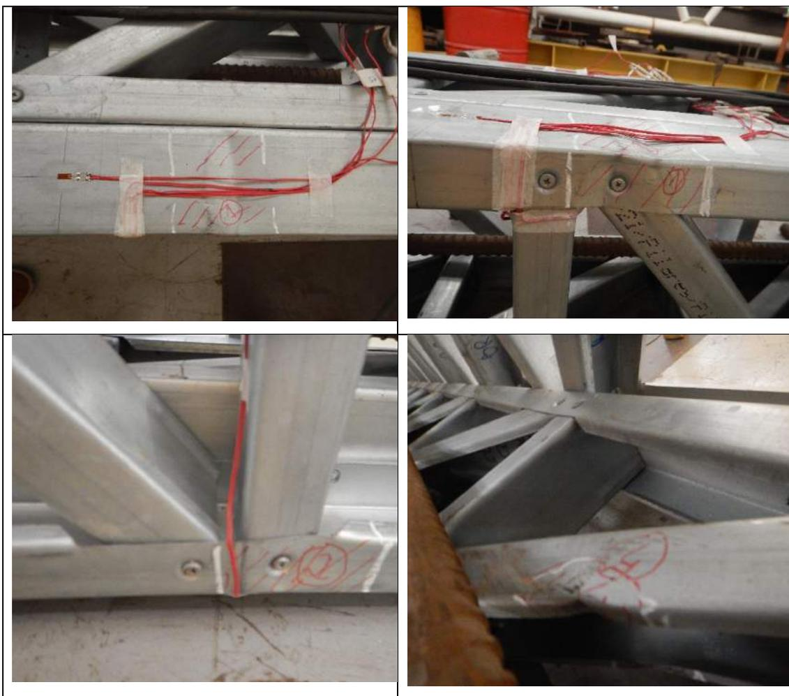
Figura A5.41 Fotos dos defeitos na coluna treliçada T16x0,8: (a) amassamento na alma do montante no meio do vão próximo ao extensômetro SG-10R (defeito 1); (b) amassamento na mesa do montante no meio do vão próximo ao extensômetro SG-10R (defeito 1); (c) amassamento do montante no meio do vão próximo ao extensômetro SG-12R (defeito 2); (d) amassamentos de diagonais e barras horizontais (defeitos 3 e 4).
