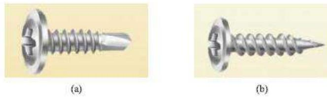
Figura 2.4 (a) TAP com ponta brocante (não necessita de pré-furação) (b) TAP com ponta agulha (necessita de pré-furação). Fonte: Catálogo Linha Steel Frame CISER.
