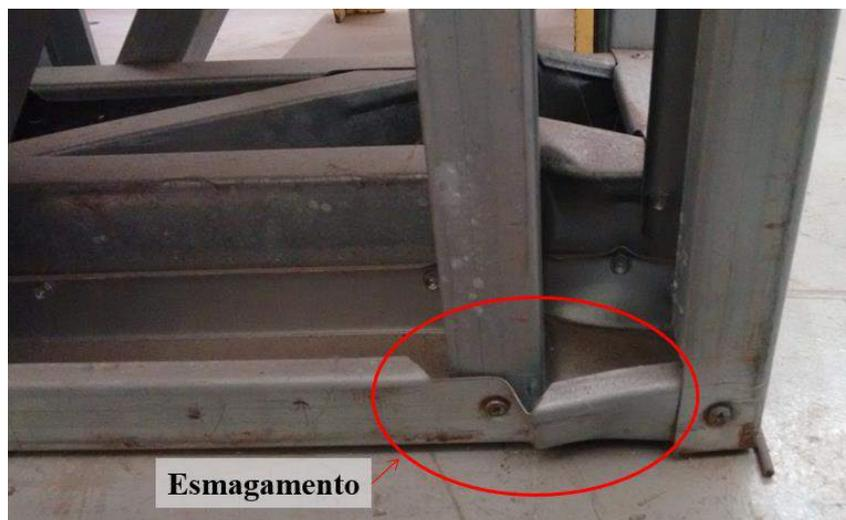
Figura 4.2: Coluna T6x0,8: mecanismo de colapso (esmagamento na cabeça da treliça).
