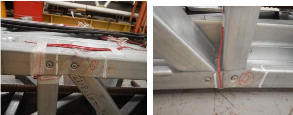
Figura A5.50 Imperfeições iniciais nos montantes superior e inferior (amassamentos marcados com caneta vermelha com os números 1 e 2).
