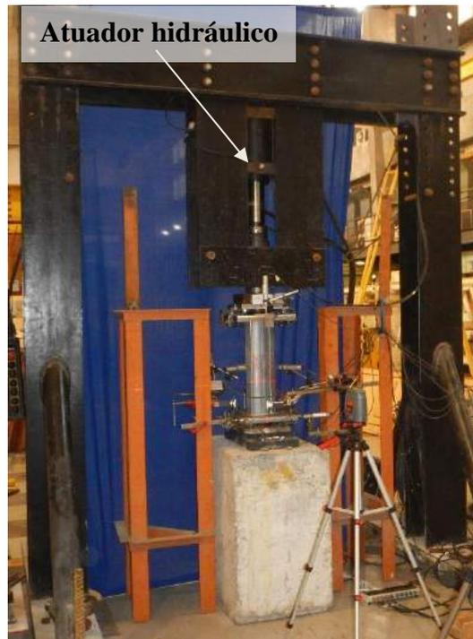
Figura 2.23: Montagem para ensaios de compressão axial: Pórtico de reação com o atuador hidráulico. Corpo de prova na posição de ensaio e utilização do laser para verificar o alinhamento.
