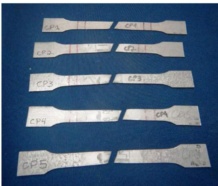
Figura 4.9 Falha característica dos corpos de prova nos ensaios de tração direta. Corpos de prova retirados das colunas treliçadas após ensaiadas.
