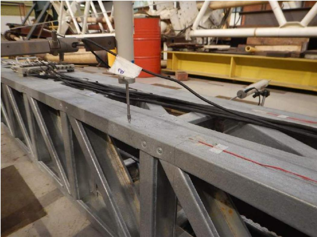
Figura A5.12 Semi-ondas de flambagem local ao longo da alma do montante para a carga de 230kN (próximo ao colapso).
