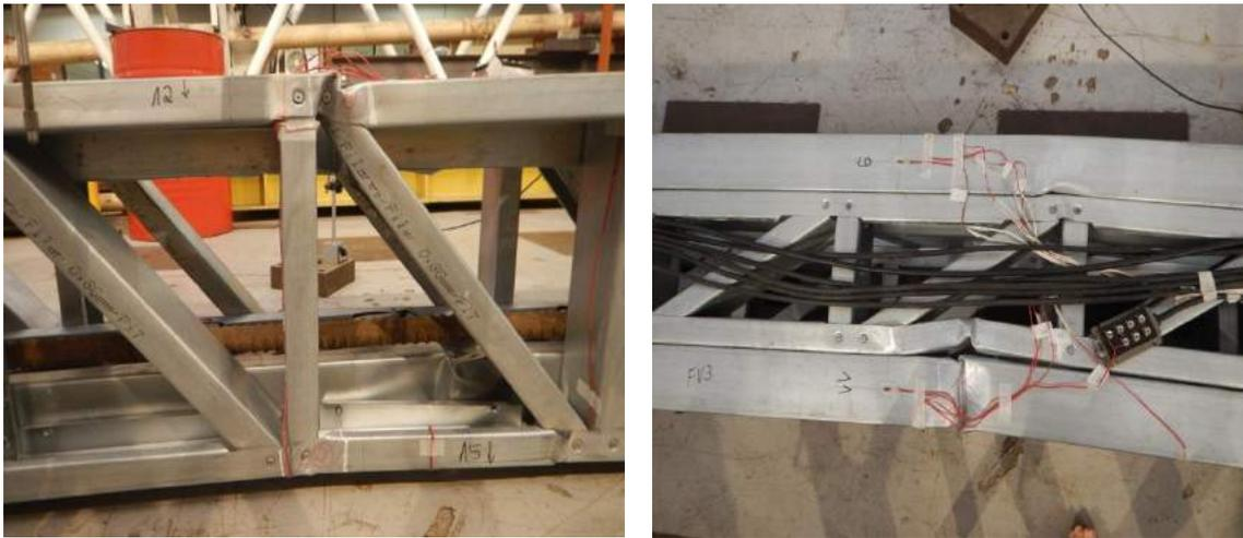
Figura A5.51 Mecanismo de colapso no meio do vão da treliça, na região onde existiam as imperfeições iniciais (marcadas com caneta vermelha). Carga aproximada de colapso:
