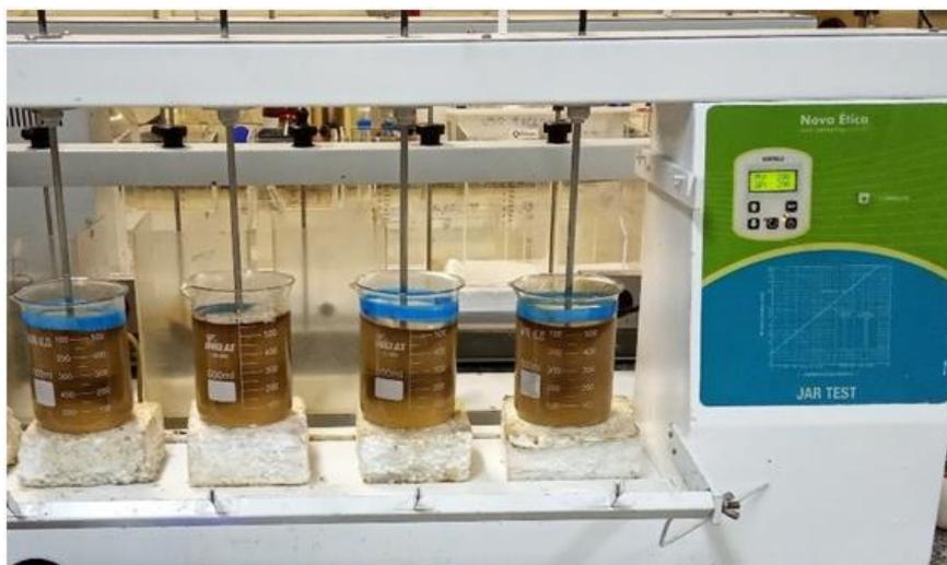
Figura 5. Jar test utilizado para a condução dos experimentos. Na imagem, efluente simulado bruto.
