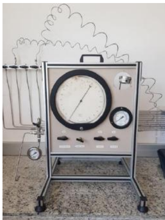
Figura 3.7 – Esquema de unidade para preparo de misturas gasosas.
