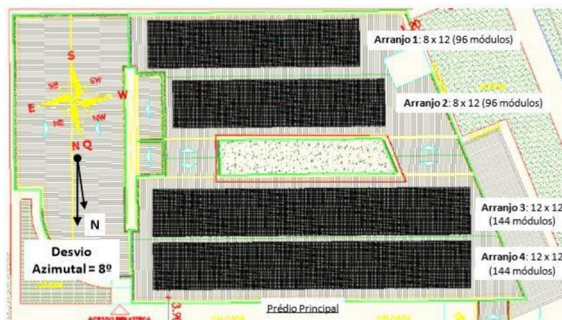
Figura 65- Vista superior da instalação da usina em Ceará Mirim
