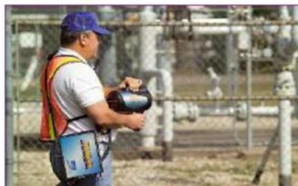
Figura 25: Exemplo de câmera de imageamento ótico e detecção de vazamento a laser.
