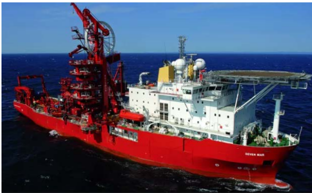
Figura 3.3-3 – Instalação pelo Costado com Torre - Fonte: Subsea 7
