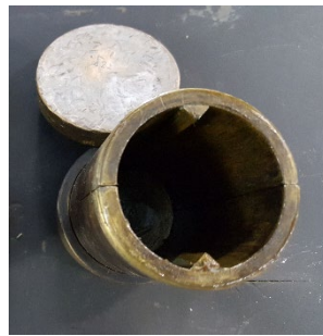
Figura 4.6 – Moldes com entalhe para indução da fissura.
