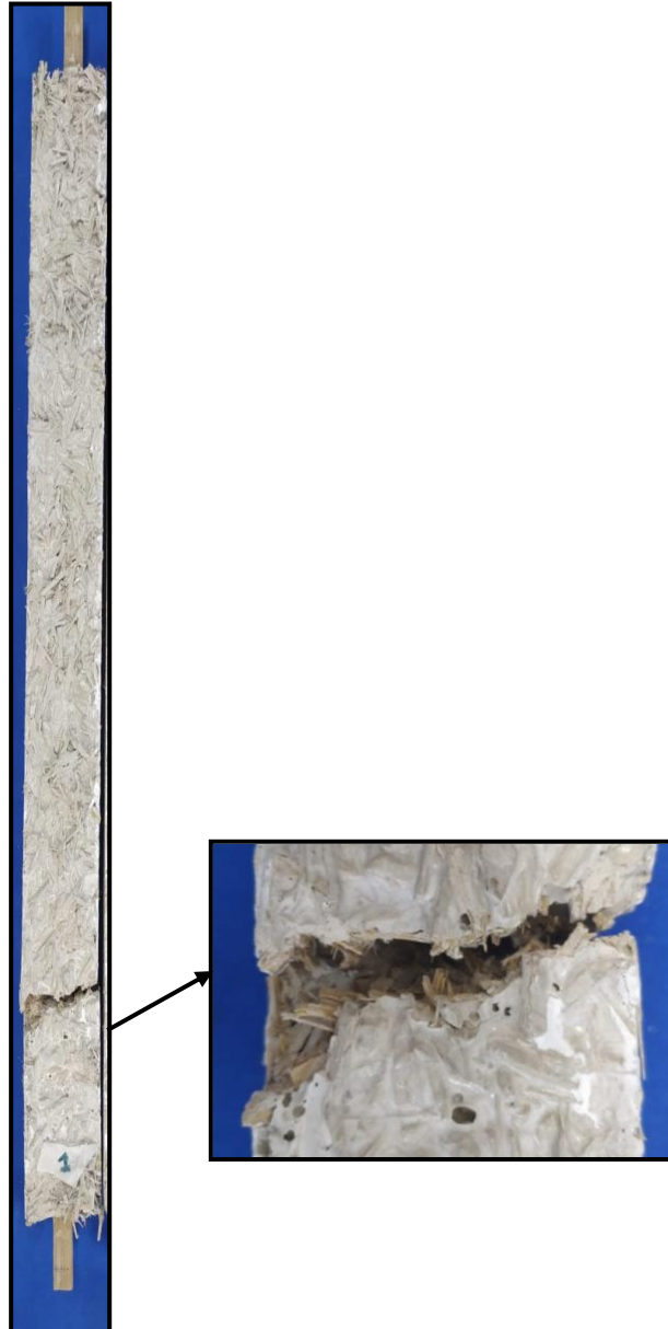
Figura 4.34- Fissuras apresentadas nos tirantes após ensaio: 45%.
