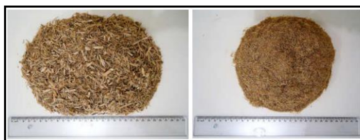
Figura 2.13 -Partículas obtidas após o processo de obtenção dos bioagregados. Fonte: Andreola (2017)
