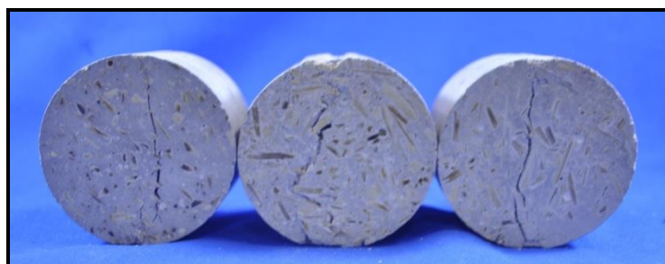
Figura 4.19- Modo de ruptura do ensaio de resistência à tração por compressão diametral.
