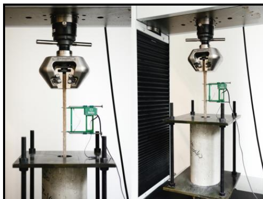
Figura 2.28- Ensaio de pull-out bambu-concreto. Fonte: Javadian et al. (2016).
