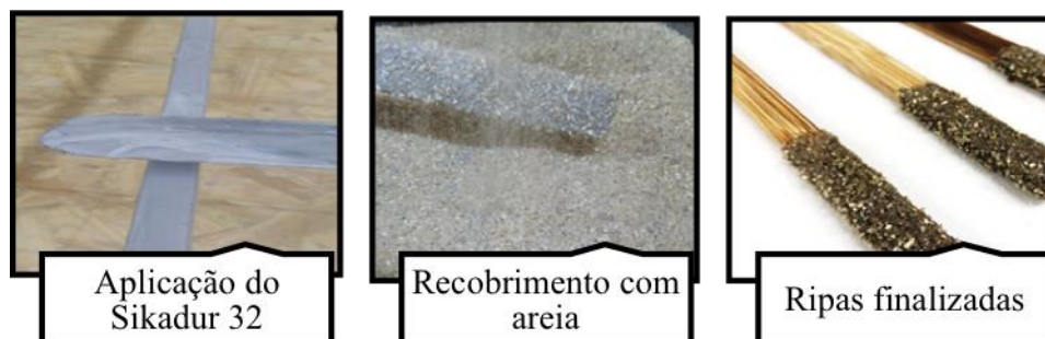
Figura 3.27- Etapas dos tratamentos das ripas de bambu.
