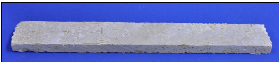
Figura 3.24- Corpo-de-prova de bioconcreto para ensaio de tração direta.
