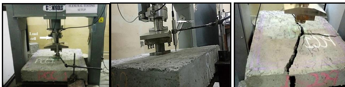
Figura 2.30- Painel PCC sendo ensaiado. Fonte: Mali et al. (2018)
