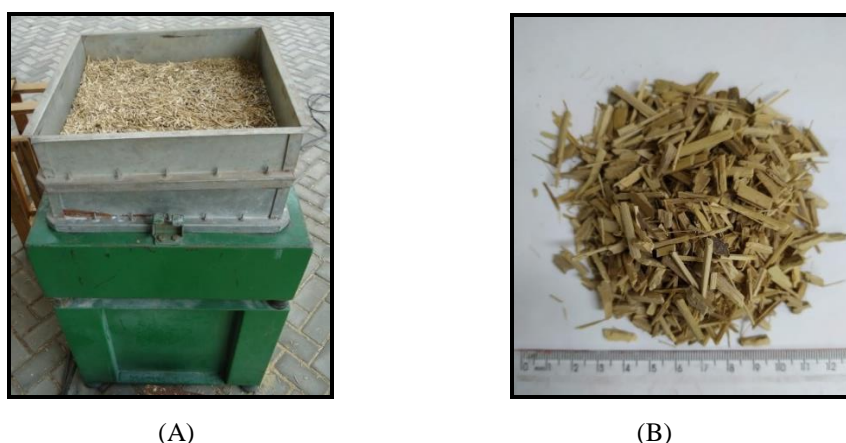
Figura 3.15- Etapa 4 da produção dos agregados: A) Peneirador mecânico; B) Agregados de bambu utilizado na pesquisa.
