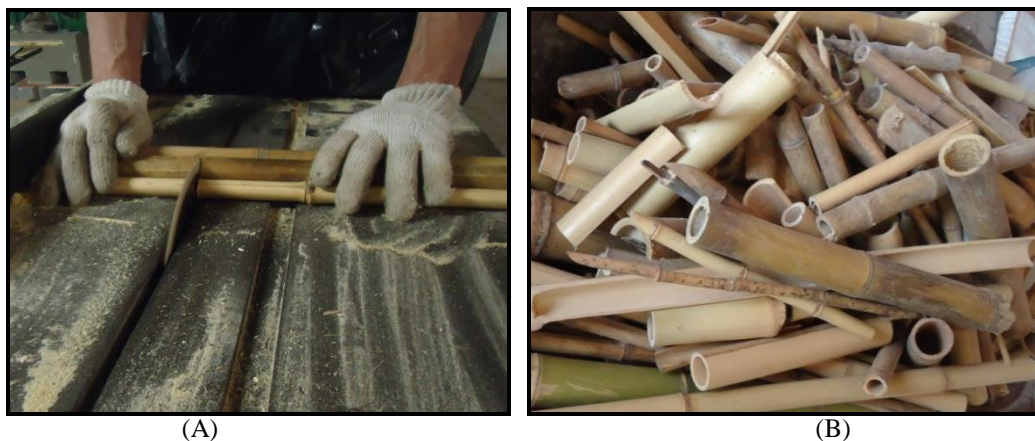
Figura 3.12- Etapa 1 da produção dos agregados: A) Corte dos resíduos de bambu em serra circular; B) Resíduos após o corte.
