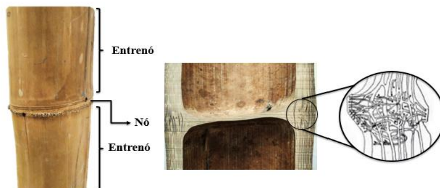
Figura 2.3- Divisão das partes do colmo e corte transversal do colmo de bambu da região interna ilustrando feixes no interior do nó.
