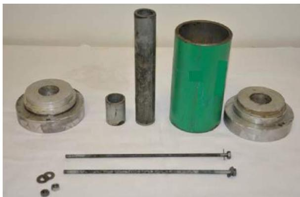
Figura 3.13: Partes dos moldes para o ensaio de aderência (PROCELAB, 2014).
