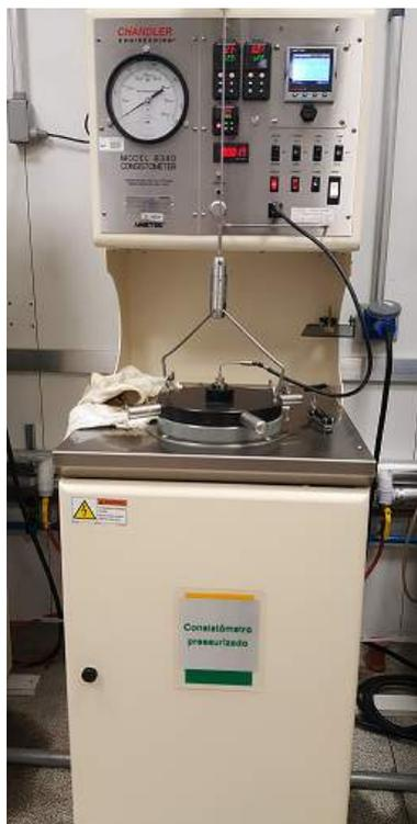
Figura 3.11: Consistômetro Pressurizado
