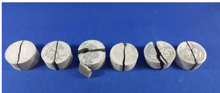
Figura 4.24: Modo de ruptura dos corpos de prova após ensaio de resistência à tração do sistema P82B1 (antes do envelhecimento).
