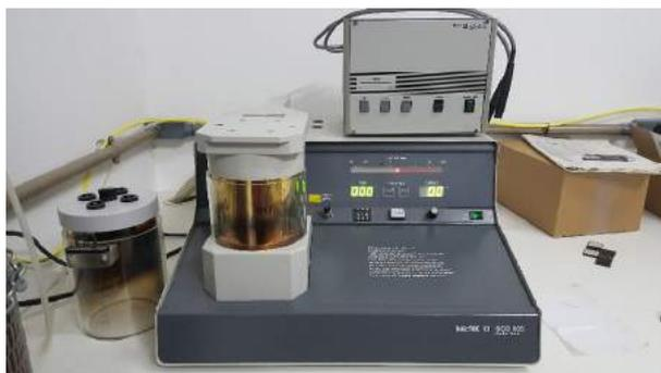
Figura 3.31: Equipamento utilizado para recobrir as amostras com ouro (BAL-TEC SCD 005)
