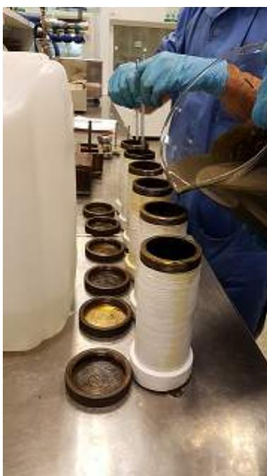
Figura 3.20: Moldagem dos corpos de prova 5 cm x 15 cm
