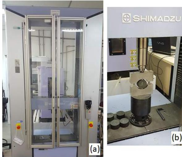
Figura 3.26: (a) Prensa Shimadzu para ensaios de compressão, (b) Ensaio do Corpo de prova
