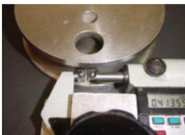
Figura 3.16: Medição da célula de teste (ISO 10426-5, 2004)
