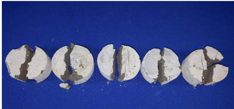
Figura 4.17: Modo de ruptura dos corpos de prova após ensaio de resistência à tração do sistema P73B2 (após o envelhecimento).
