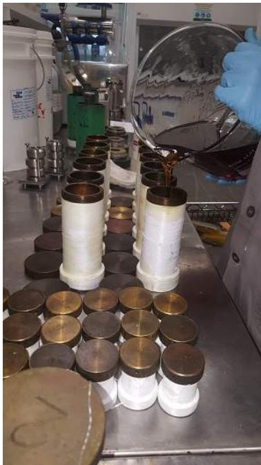
Figura 3.23: Preenchimento dos moldes 5 cm x 15 cm o sistema de resina epóxi
