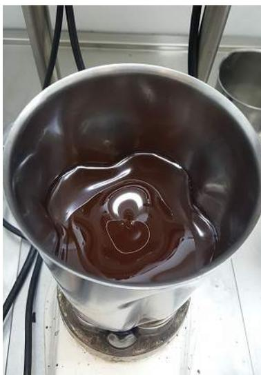
Figura 3.22: Homogeneização do sistema de resina epóxi no misturador
