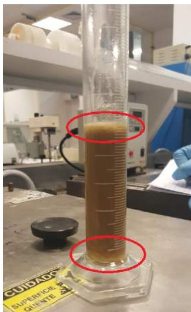
Figura 4.1: Filtrado da pasta P75 indicando a presença de resina na base e topo da proveta
