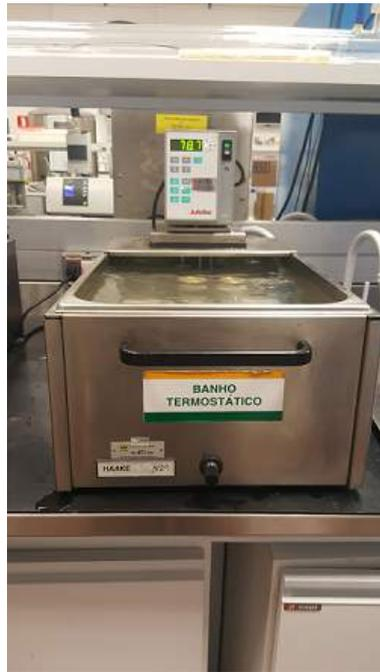
Figura 3.21: Cura dos Corpos de prova em banho térmico (CENPES) à temperatura de 174 °F (79 °C )
