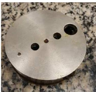
Figura 3.15: Célula de teste para o ensaio de retração e expansão
