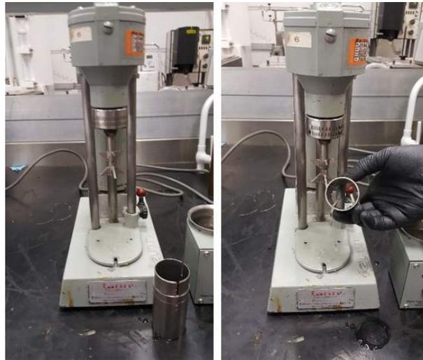
Figura 3.7: Viscosímetro FYSA.
