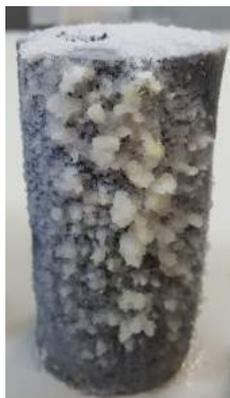
Figura 4.15: Deposição de sal na superfície dos corpos de prova da pasta expansível envelhecido em solução de salmoura por 60 dias
