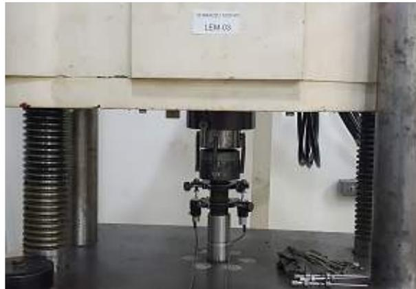
Figura 3.25: Prensa Shimadzu para ensaios de compressão uniaxial
