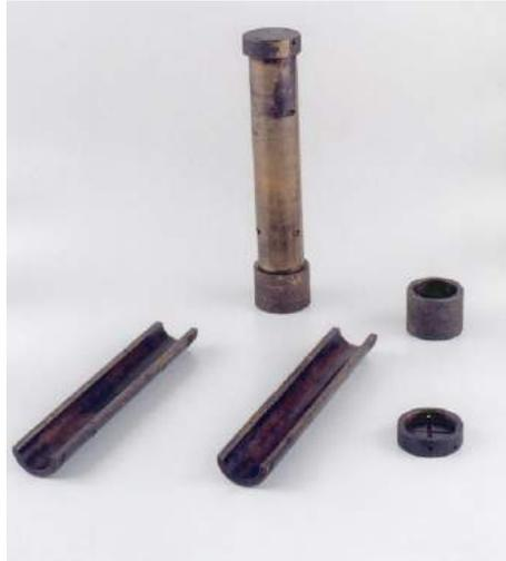
Figura 3.8: Tudo decantador bi-partido para ensaios de sedimentação (PROCELAB, 2014).
