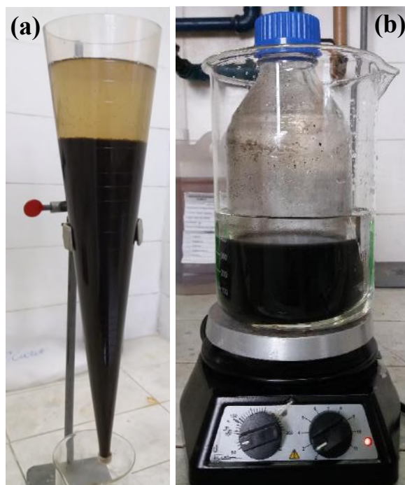
Figura 8. Tratamento do lodo anaeróbio: (a) Concentração de sólidos do lodo em cone de sedimentação; (b) Sistema de pré-tratamento térmico do lodo anaeróbio.
