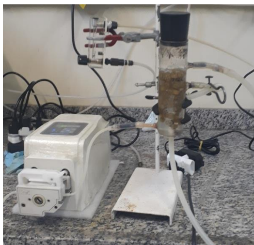
Figura 4.4 – Unidade experimental ilustrando o sistema MBBR e seus componentes.
