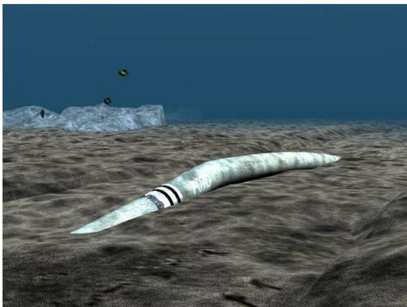
Figura 6: Duto com trechos enterrados e expostos. Fonte: http://www.neil-brown.com/pipeline-geotechnics-our-entry-points-for-design
