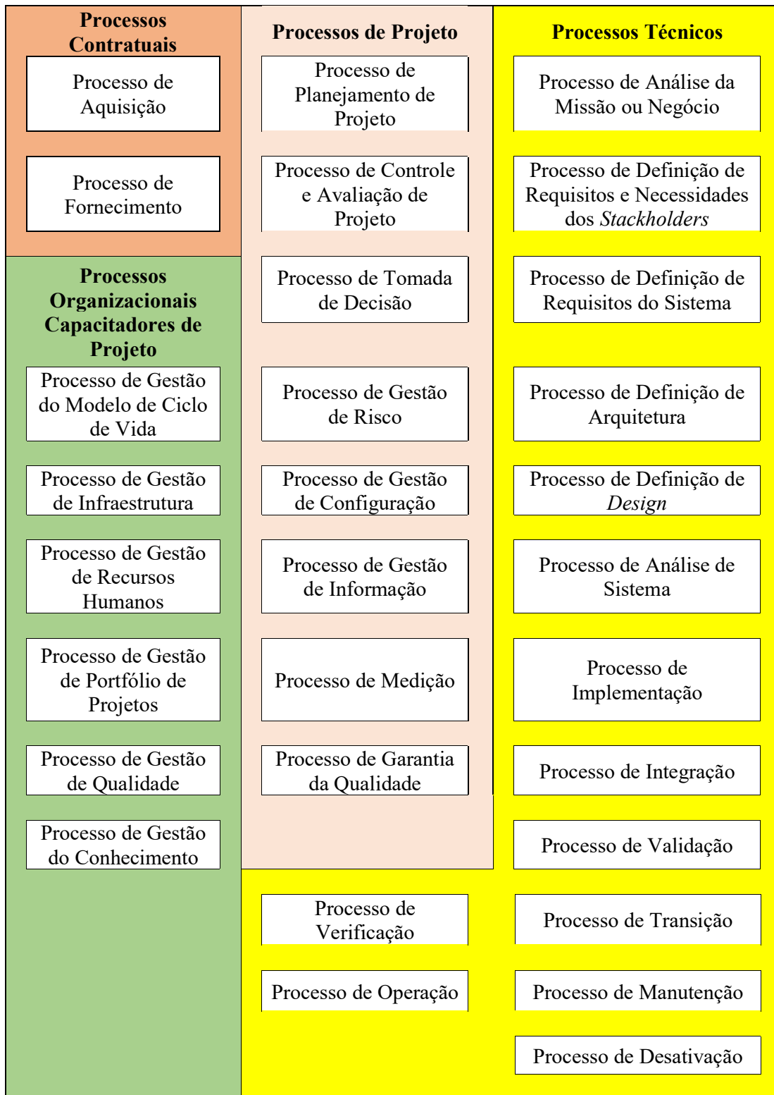
Figura 22: Processos do ciclo de vida de sistemas Fonte: Adaptado de ISO/IEC/IEEE 15288:2015[5]
