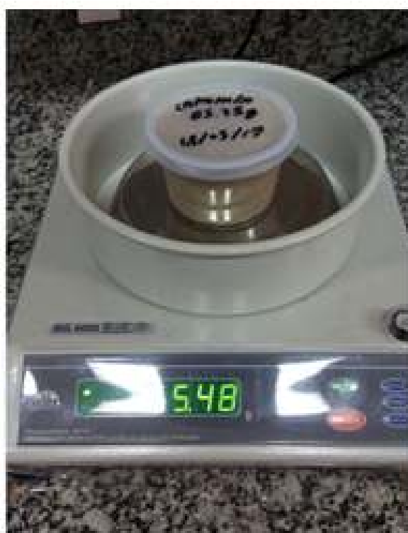
Figura 8- Balança de precisão utilizada para a medição das massas das amostras.
