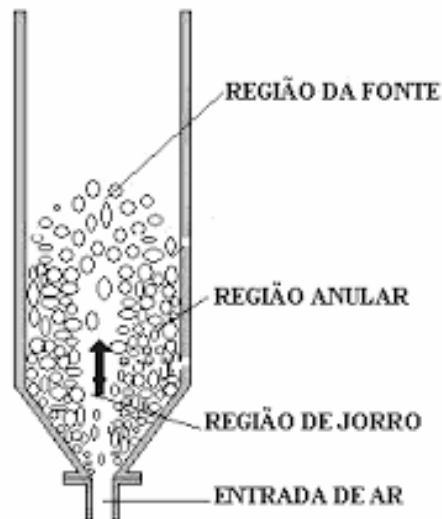
Figura 2.2: Desenho esquemático de um leito de jorro.
