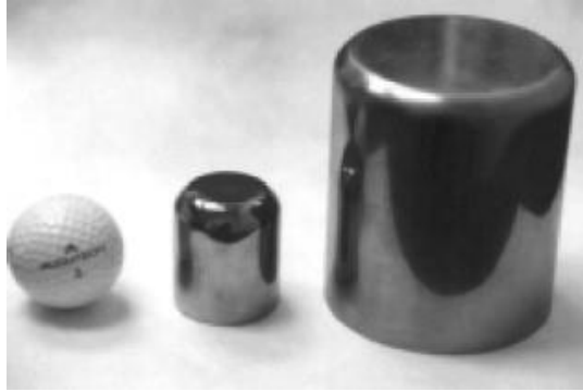
Figura B. 2: Comparação entre os tamanhos de um cristal de HPGe com 15% e 150% de eficiência em relação a uma bola de golfe.
