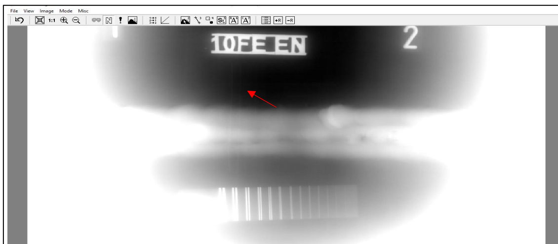
Figura 65: Verificação do IQI de fio simples.
