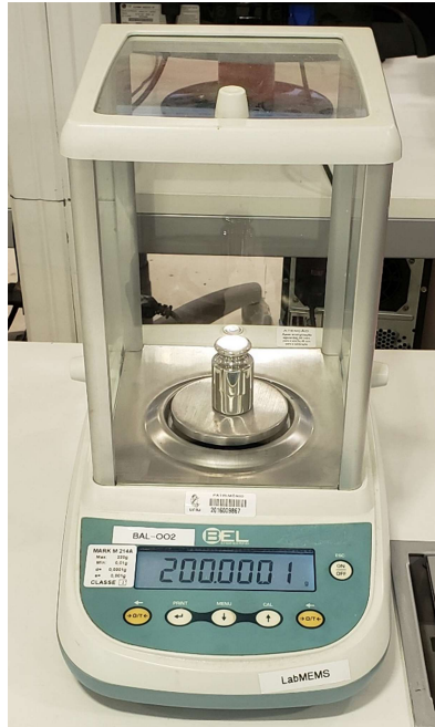
Figura A.2 - Balança Analítica BAL-002 do LABMEMS durante processo de calibração
