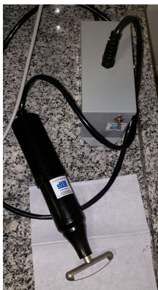
Figura 3.10 - Equipamento “ Laboratory Corona Treater ”, modelo BD-20AC, da fabricante Electro-Technic Products, utilizado para produzir a descarga corona sobre a superfície dos materiais, disponível no LABMEMS.
