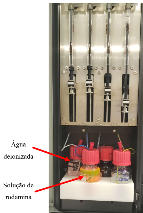
Figura 3.16 - Sistema de bombeamento e injeção do goniômetro, disponível no LRAP.
