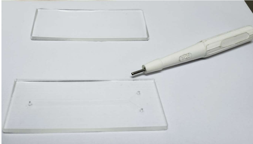
Figura 3.8 - Camada de PDMS contendo o microdispositivo já com os acessos (furos) feitos com o punch dermatológico e a camada de PDMS que servirá como tampa do microdispositivo.
