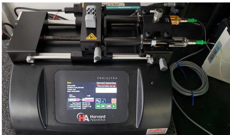
Figura 4.17 – Bomba de seringa com as seringas de vidro, uma contendo a solução de rodamina e a outra água deionizada, usada nos experimentos com o \mu -LIF.
