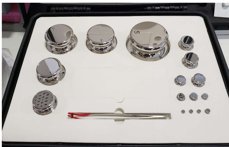
Figura A.1 - Coleção de pesos-padrão empregados na calibração da BAL-002 do LABMEMS
