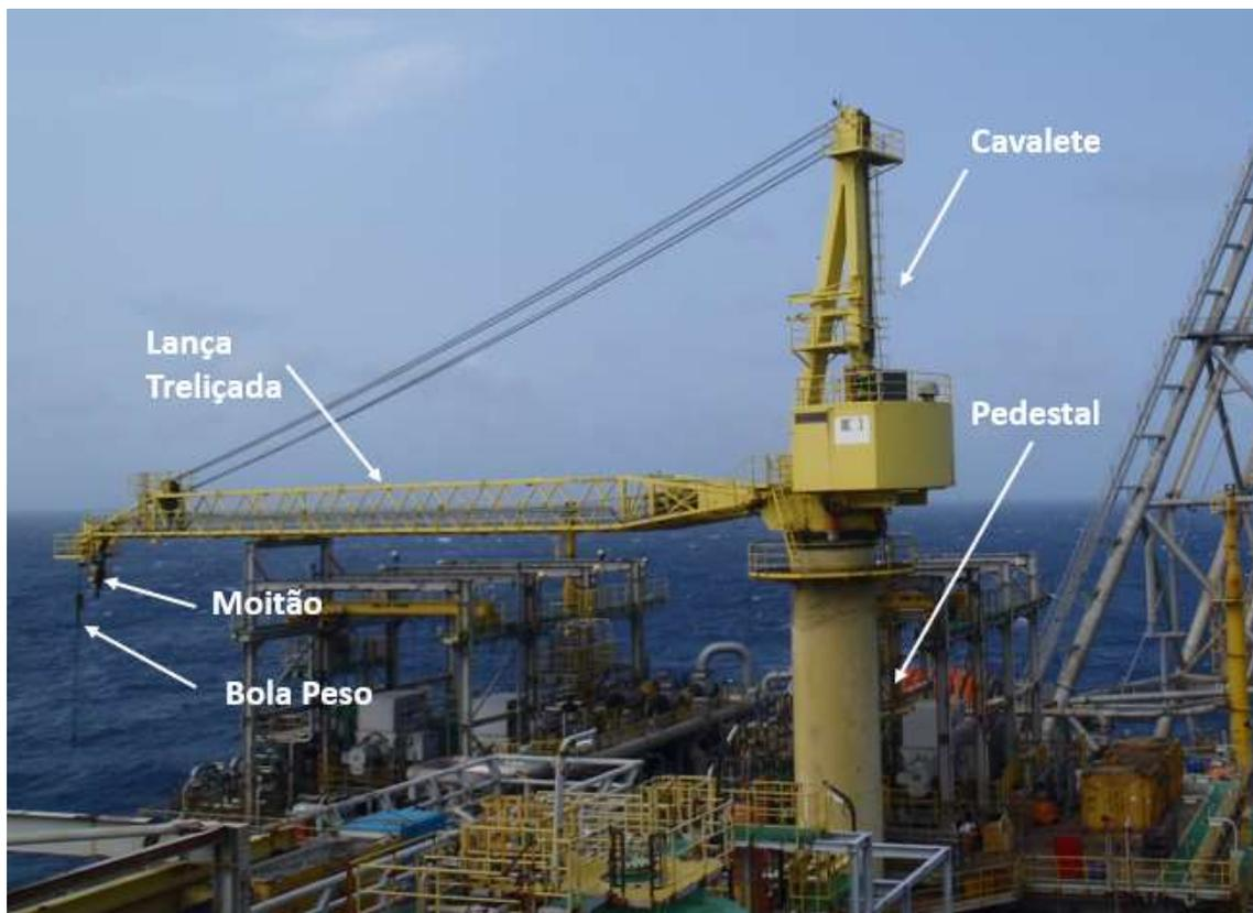
Figura 03: Principais partes de um guindaste *offshore* de lança treliçada. *Fabricante National Oilwell Vargo (NOV), modelo OC 3000 LE, instalado em P-54.*
