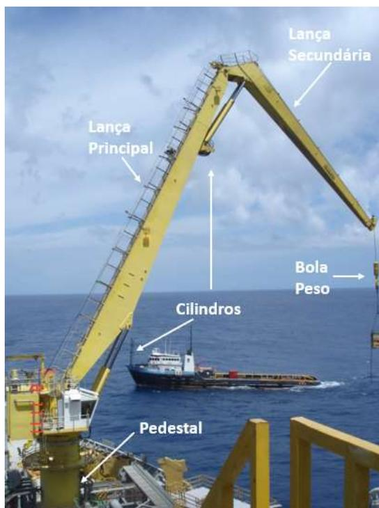
Figura 04: Principais partes de um guindaste *offshore* de lança articulada. Fabricante Hydralift, modelo C3036KE, instalado em P-43.
