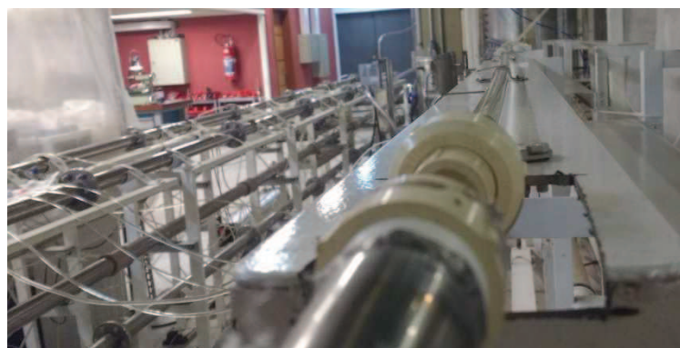
Figura 4: Vista da seção final do trecho em acrílico do circuito experimental. Ao fundo se vê o tanque de 70 litros e pela lateral esquerda se vê os capilares de transmissão de pressão até os transdutores, em catenária livre até a bancada.
