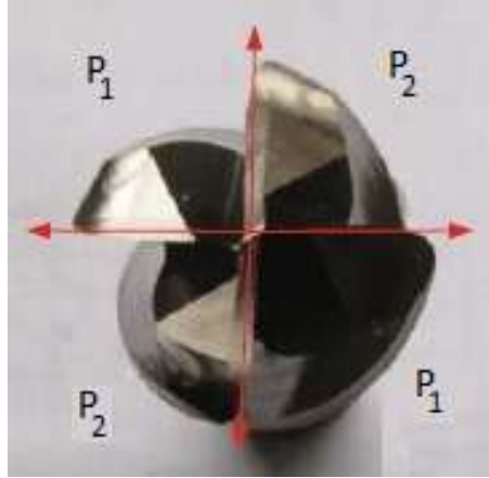
Figura 2.18: Fresa genérica de passo diferenciado (adaptado de SONG et al. (2011))
