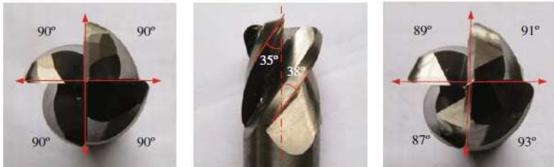
(a) Fresa com passo angular constante (b) Fresa com ângulo de hélice variável (c) Fresa com passo angular diferenciado
