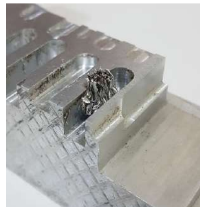
(b) Canal obstruído por cavaco
