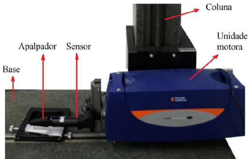
Figura 3.3: Perfilômetro mecânico com apalpador (Stylus) (CABRERA, 2015)
