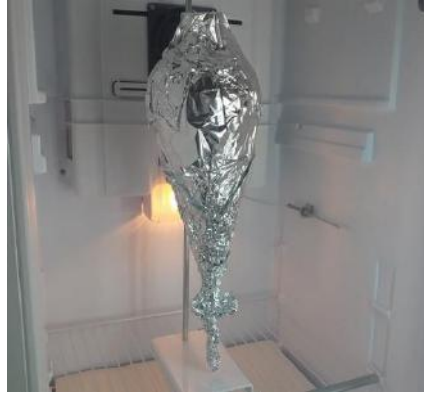
Figura III.8 – Incubação do frasco contendo cistos de Artemia sp. para eclosão.
