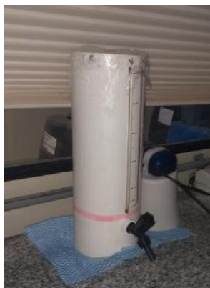
Figura III.6 – Reservatório de água do mar reconstituída e sistema de aeração.
