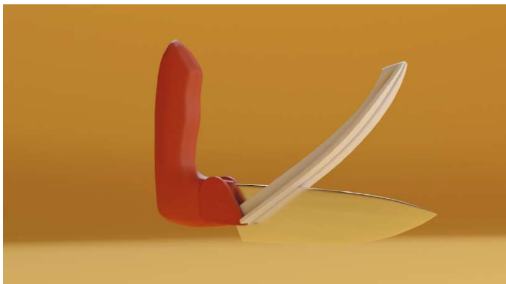
Figura 47 – Faca de corte com limitador acionado. Fonte: Elaboração própria
