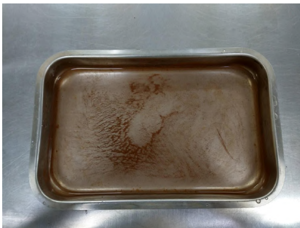
Figura 20 – Bandeja de aço com líquido contendo o pó do material oxidado da barra e água deionizada.
