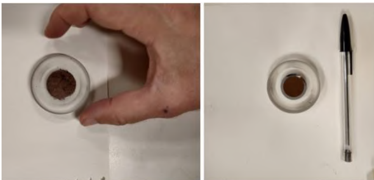
Figura 23 – À esquerda, material original da barra disposto em suporte silício clivado zero – background e à direita, material oxidado da barra disposto em suporte com background de silício.
