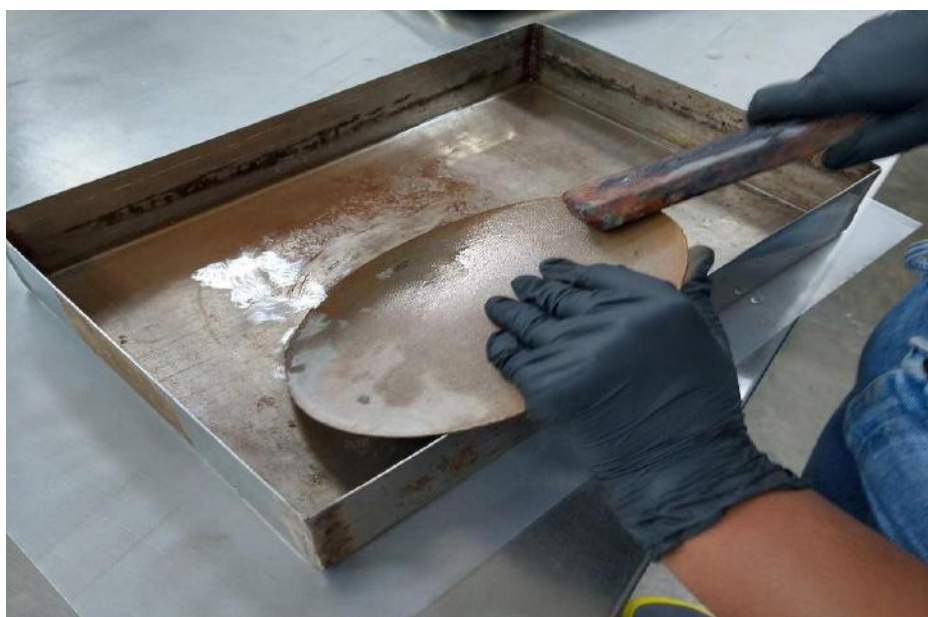
Figura 18 – Processo de desbaste da barra, com lixa diamantada, para obtenção do pó oxidado.
