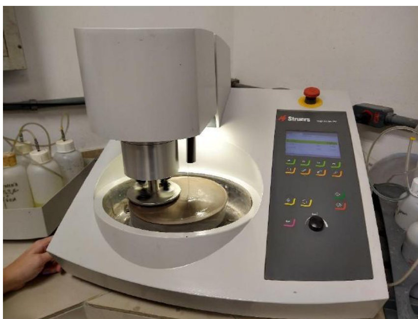
Figura 25 - Processo de polimento das seções em politriz automática.
