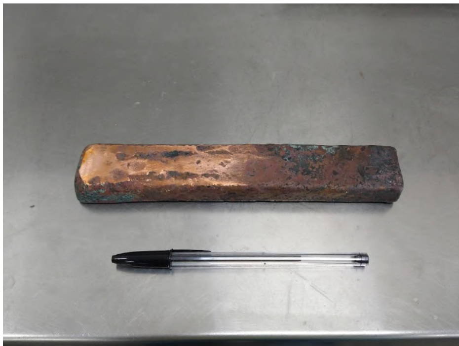
Figura 19 - Barra de cobre do Jauru após abrasão da camada superficial, expondo o material original da barra, à esquerda, e a porção oxidada, à direita.
