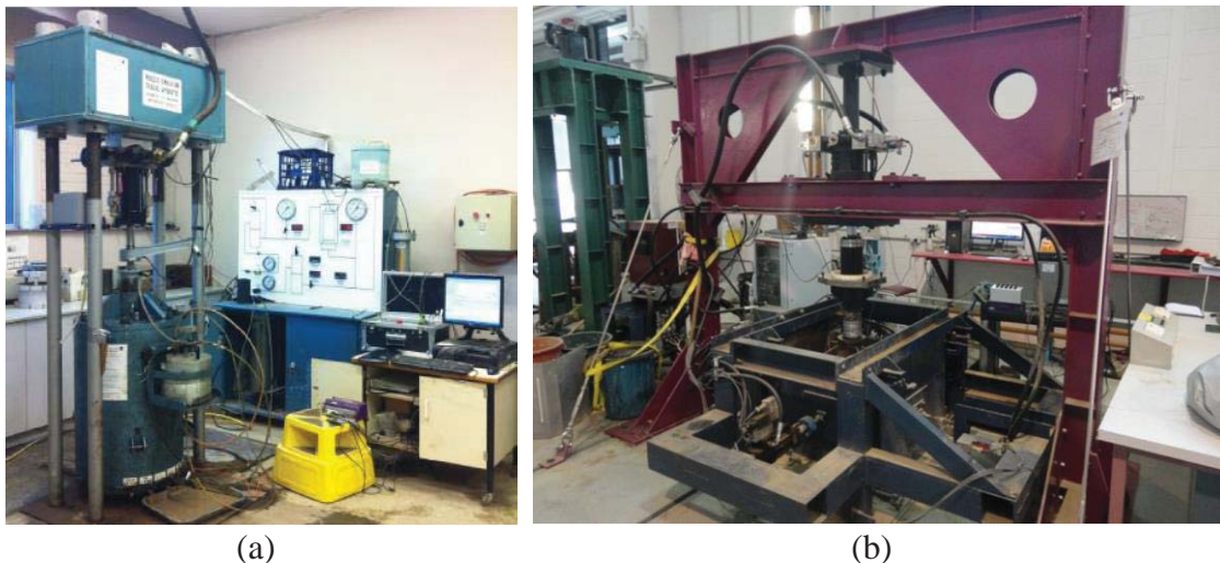
Figura 2.30 – Equipamentos para ensaio do lastro na Universidade de Wollongong (Austrália): (a) Triaxial cilíndrico; (b) Triaxial Prismoidal.
