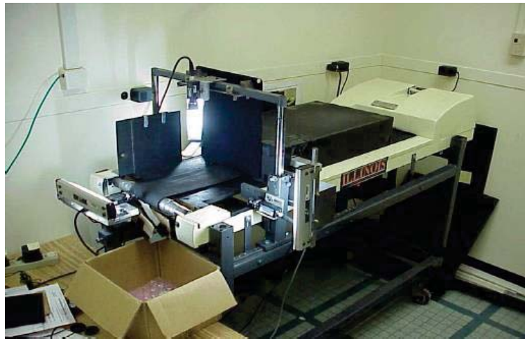
Figura 2.11 – Equipamento UIAIA de medida de características físicas de agregados Fonte: Huang (2010)
