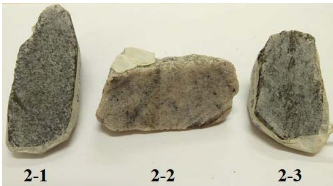
Figura 5.3 – Amostras do Material 2 selecionadas para lâminas petrográficas
