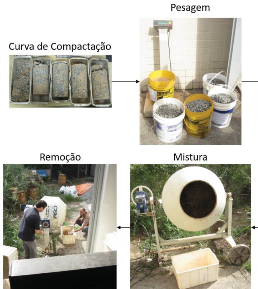
Figura 3.19 – Preparo do material para sublastro desta pesquisa
