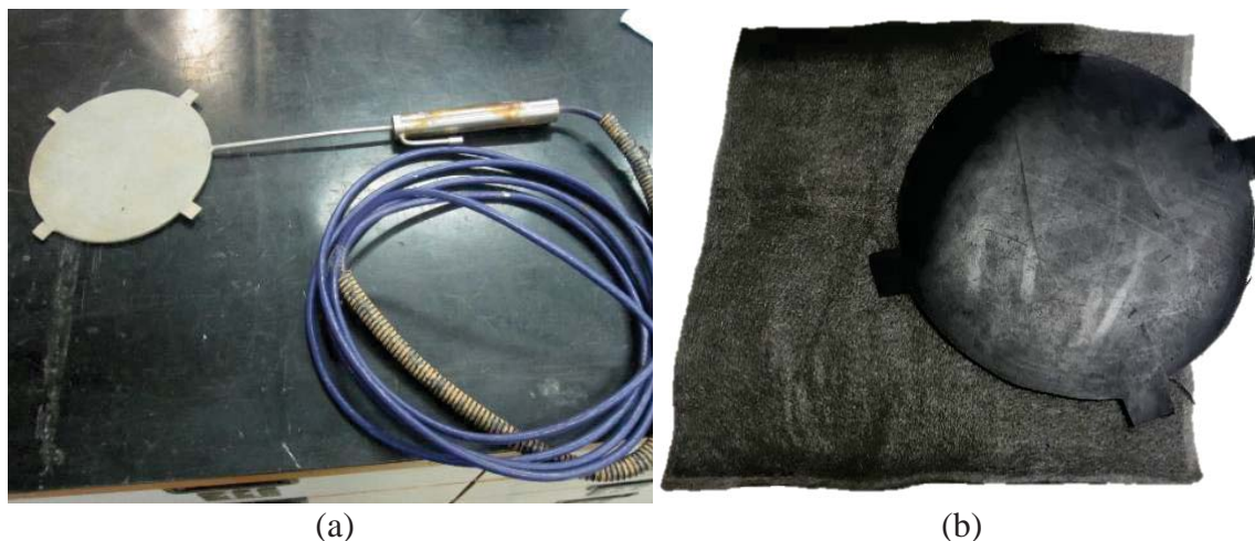
Figura 4.9 – Instrumentação para aquisição de tensões no modelo físico desta pesquisa: (a) Célula de pressão total; (b) Materiais utilizados para proteção da célula
