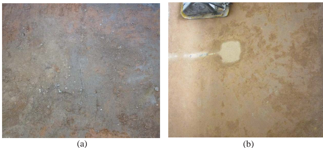
Figura 3.15 – Subleito do modelo físico: (a) antes; (b) depois da remoção de pequena parte do material superficial para a presente pesquisa
