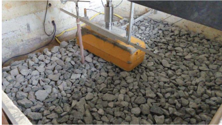
Figura 3.25 – Estrutura montada do quinto ensaio desta pesquisa – Lastro 5 representativa de todos os cenários desta pesquisa no tanque teste
