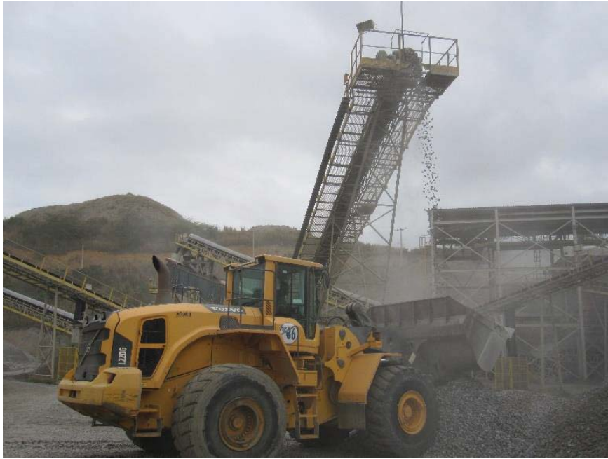
Figura 3.12 – Coleta do material britado para diferentes APF numa pedreira para esta pesquisa
