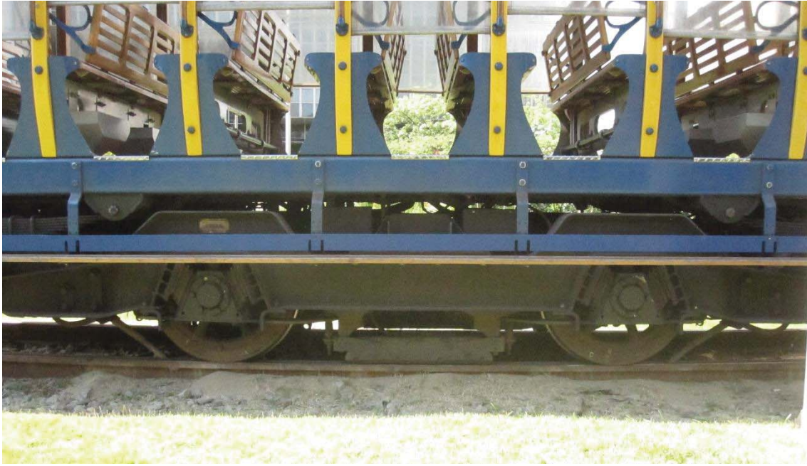
Figura 4.20 – Truque do bonde de Santa Teresa usado para medir tensões no lastro nesta pesquisa
