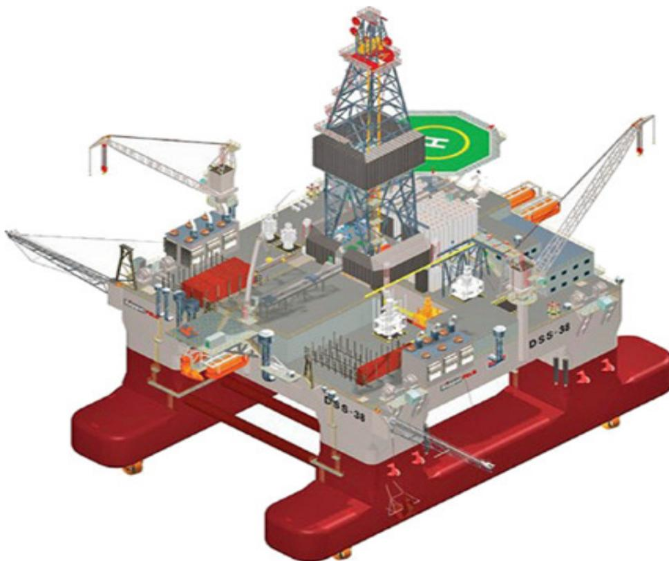
Figura 1 - Semi-submersível com sistema ativo de ancoragem (BAI & BAI[23])
