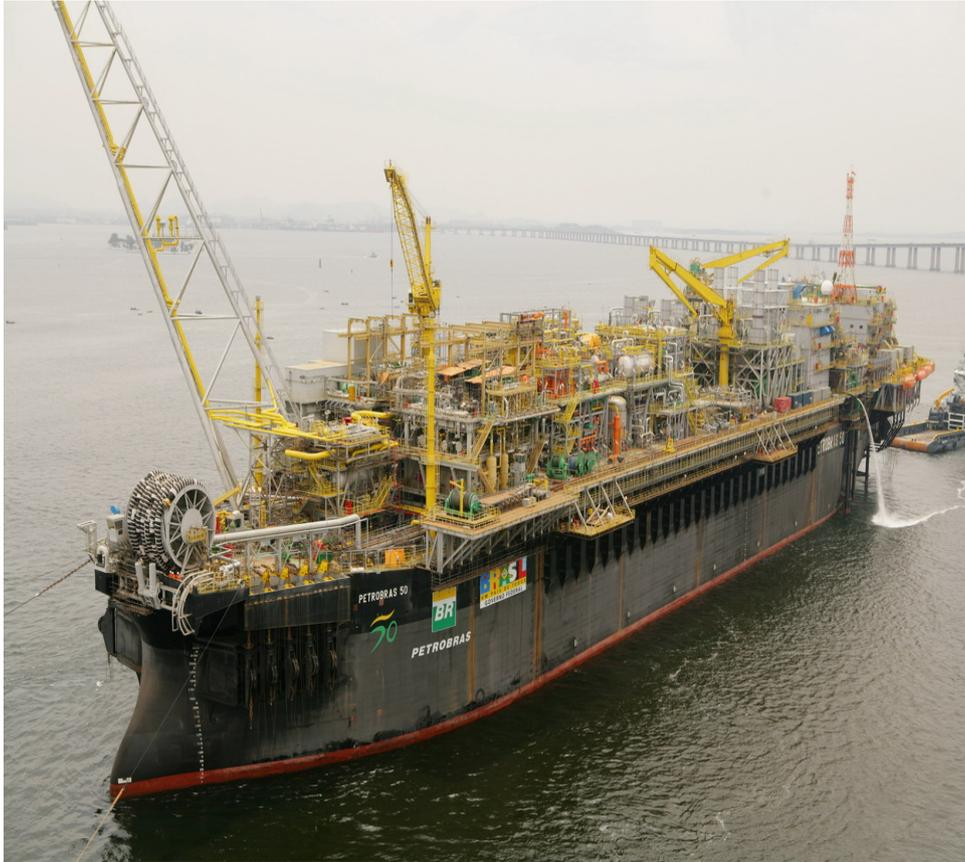
Figura 4 - FPSO (P-50) com sistema de ancoragem em *spread mooring*
