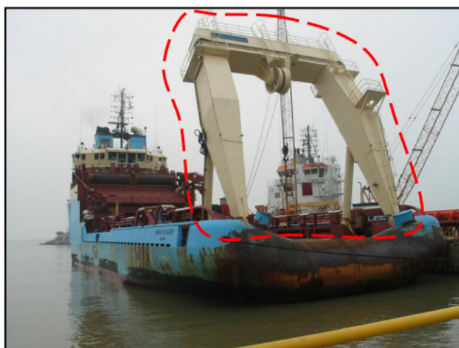
Figura 3.2 - Embarcação de instalação de equipamentos pelo método vertical via cabo com a utilização de A-frame. [26]
