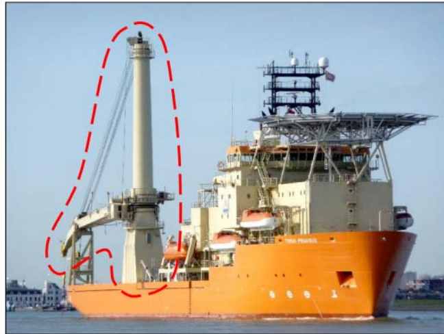
Figura 3.3 – Embarcação de instalação de equipamentos pelo método vertical via cabo com a utilização de guindaste. [26]
