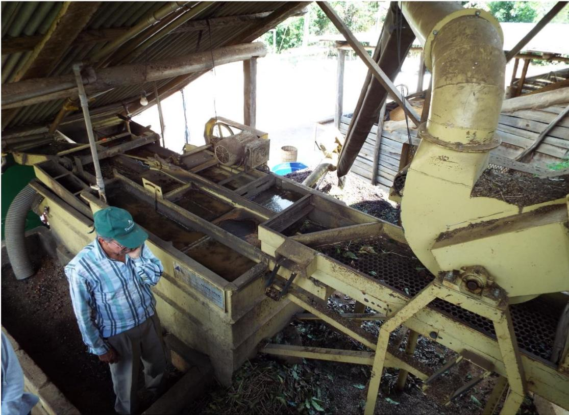
*Figura A.8 Estrutura de lavador agregado ao despulpador.*
