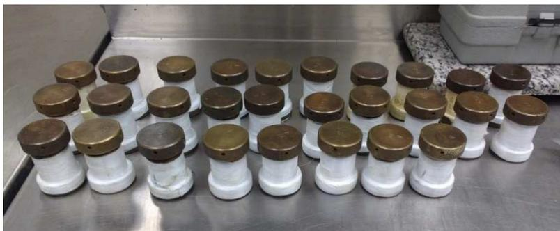
Figura 23: Moldes cilíndricos 25mm x 50mm utilizados para realizar a cura das pastas cimentícias.
