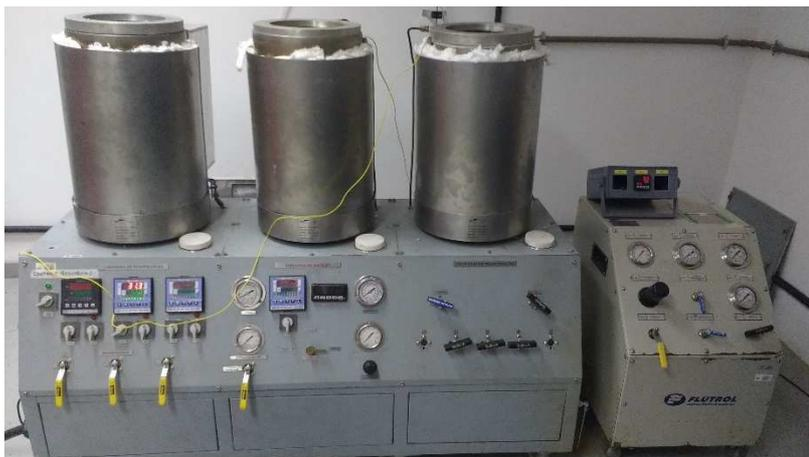
Figura 47: Autoclave da ICSS com 3 vasos de pressão. Foto retirada da sala de carbonatação do Labest/UFRJ.
