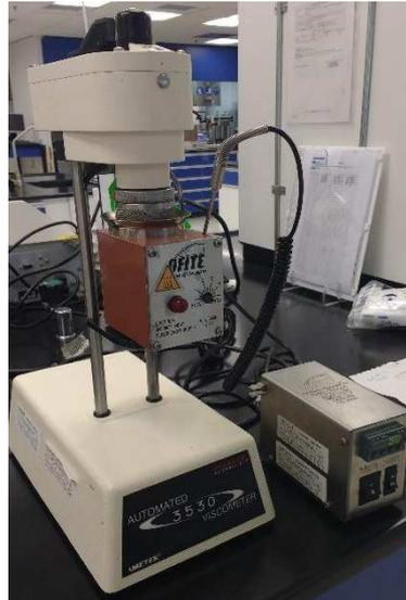
Figura 29: Viscosímetro utilizado no ajuste das pastas. Foto tirada do laboratório de cimentação da Schlumberger.
