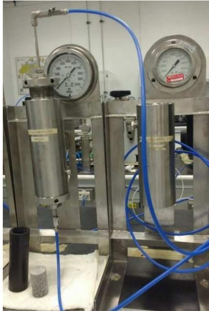
Figura 40: Permeâmetro Utilizado na caracterização da pasta. Foto retirada do laboratório do CENPES.
