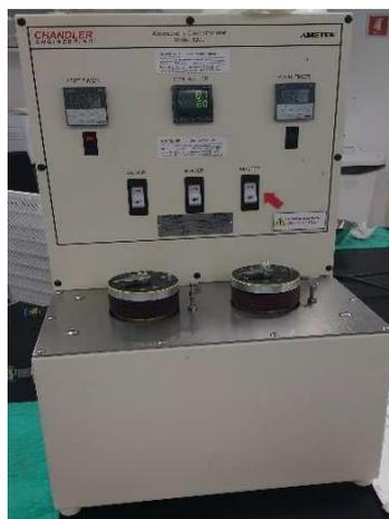
Figura 22: Consistômetro Atmosférico utilizado no condicionamento das pastas. Foto tirada do laboratório de cimentação da Petrobras/ CENPES.
