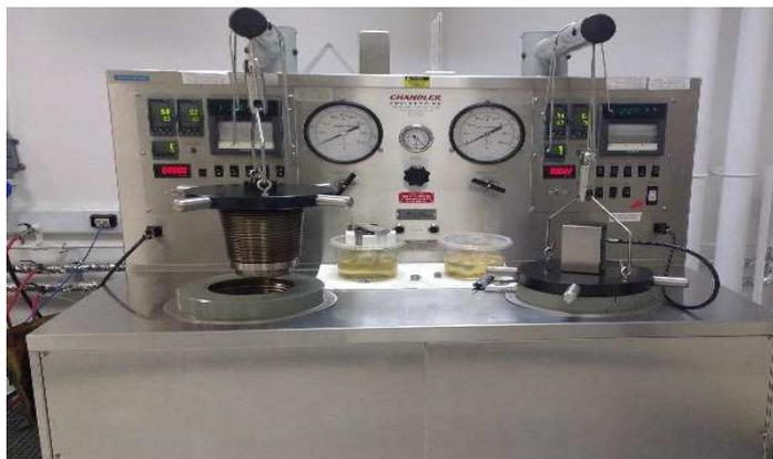
Figura 30: Consistômetro Pressurizado utilizado no condicionamento das pastas. Foto tirada do laboratório de cimentação da Petrobras/ CENPES.
