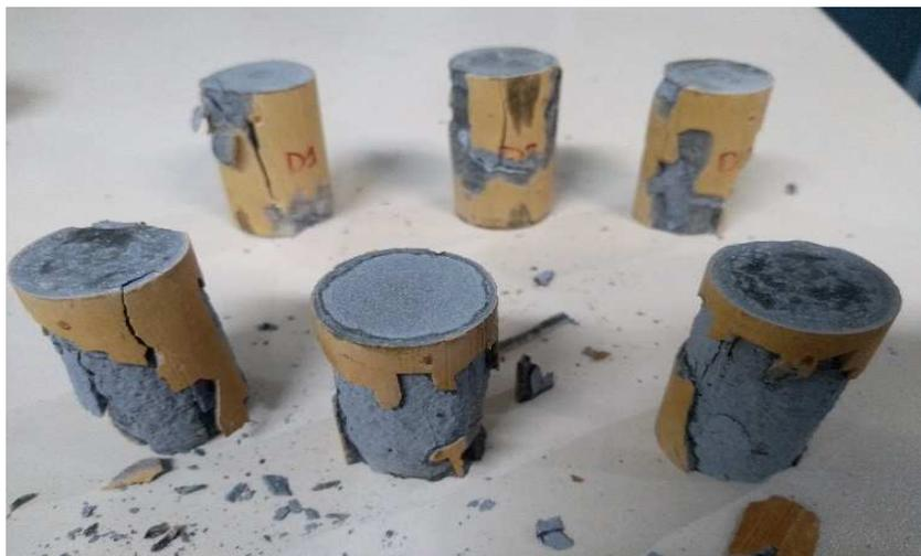
Figura 98: Amostras carbonatadas por 60 dias após o ensaio de compressão axial.
