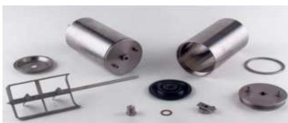
Figura 31: Célula rotativa utilizada no consistômetro (PROCELAB, 2005).
