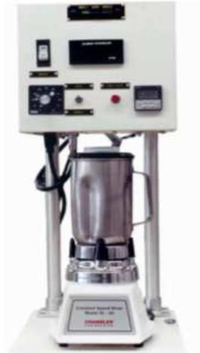
Figura 21: Exemplo de Misturador do tipo utilizado no preparo das pastas Waring Blendor (PROCELAB, 2005).
