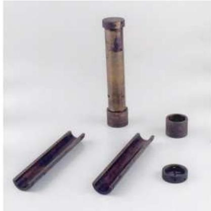
Figura 34: Exemplo de Tubo decantador bipartido utilizado no ajuste das pastas (PROCELAB, 2005).
