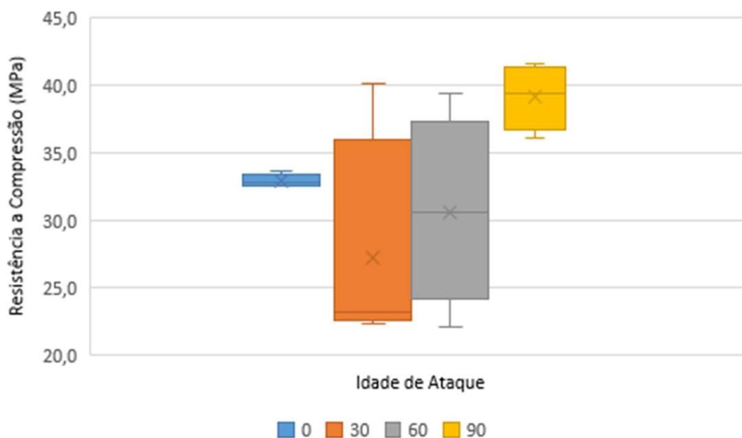
Figura 107: Diagrama de Caixa do ensaio de resistência compressiva axial da pasta PR+L, em função do tempo de ataque.
