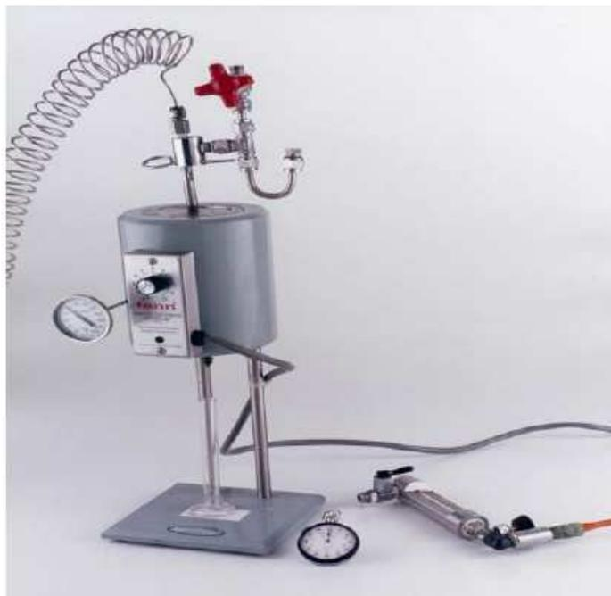
Figura 33: Exemplo de Filtro Prensa BTAP (PROCELAB, 2005).
