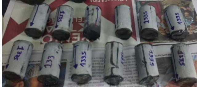
Figura 43: Corpos de prova com resina em suas bases e topos, antes de serem submetidas ao ataque ácido.
