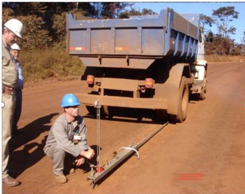
Figura 2.15 - Esquema da utilização em campo da Viga Benkleman (SOLOCAP, 2018).
