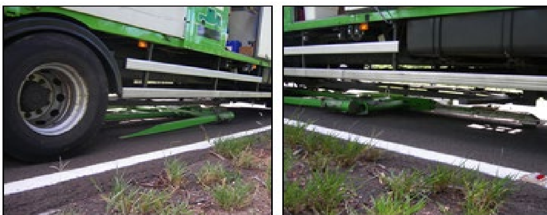
Figura 2.16 - Detalhe do deflectógrafo Lacroix (Vectra-Esteio Rodovias, 2012).
