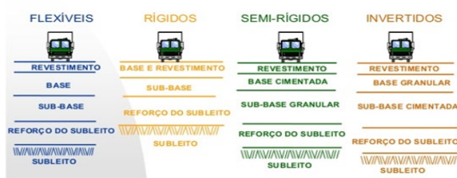
Figura 2.1 - Tipos de estruturas de pavimentos rodoviários (ADADA, 2008).
