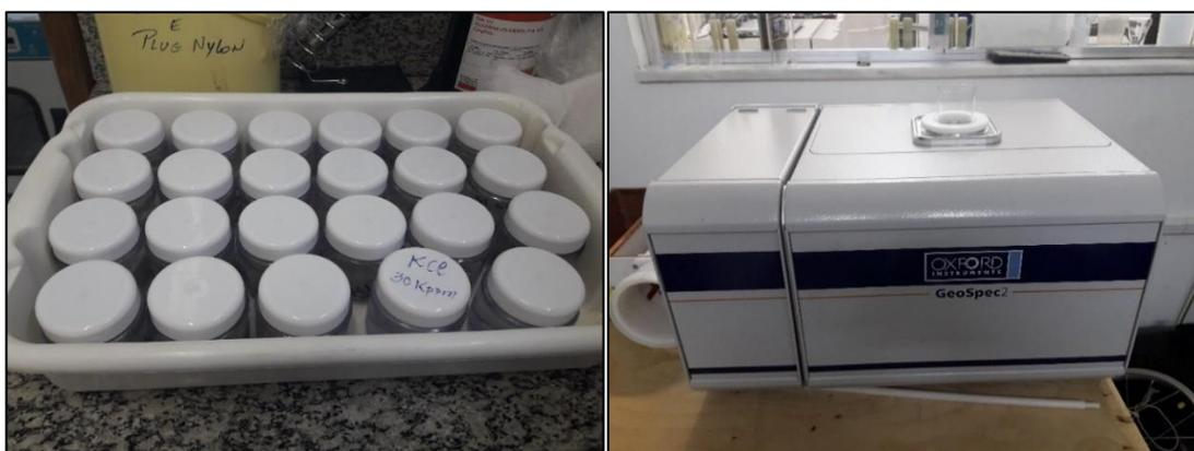
Figura 21. (A) Amostras guardadas em potes preenchidos por salmoura (KCl 30 Kppm) para não haver escape de fluido antes da leitura pelo equipamento. (B) Equipamento GeoSpec2 do UFFLAR, utilizado neste trabalho.
