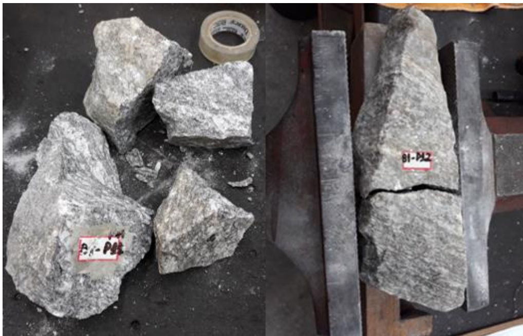
Figura 4.7 – Amostras rompidas durante o ensaio devido ao aperto da morsa.
