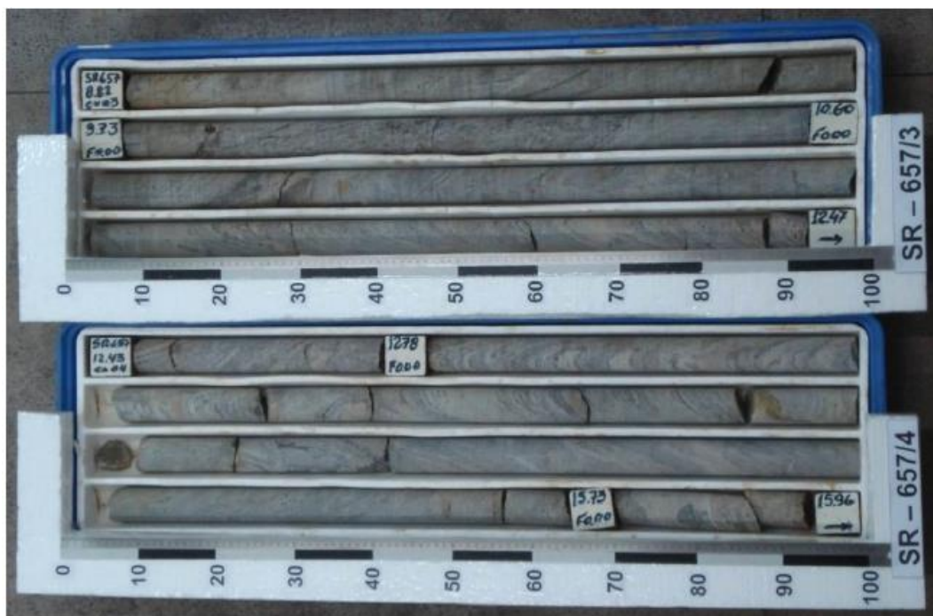
Figura 3.13 – Testemunho recuperado do furo de sondagem SR – 657: Profundidade de 8,82 a 15,96m (SALLES, 2013).
