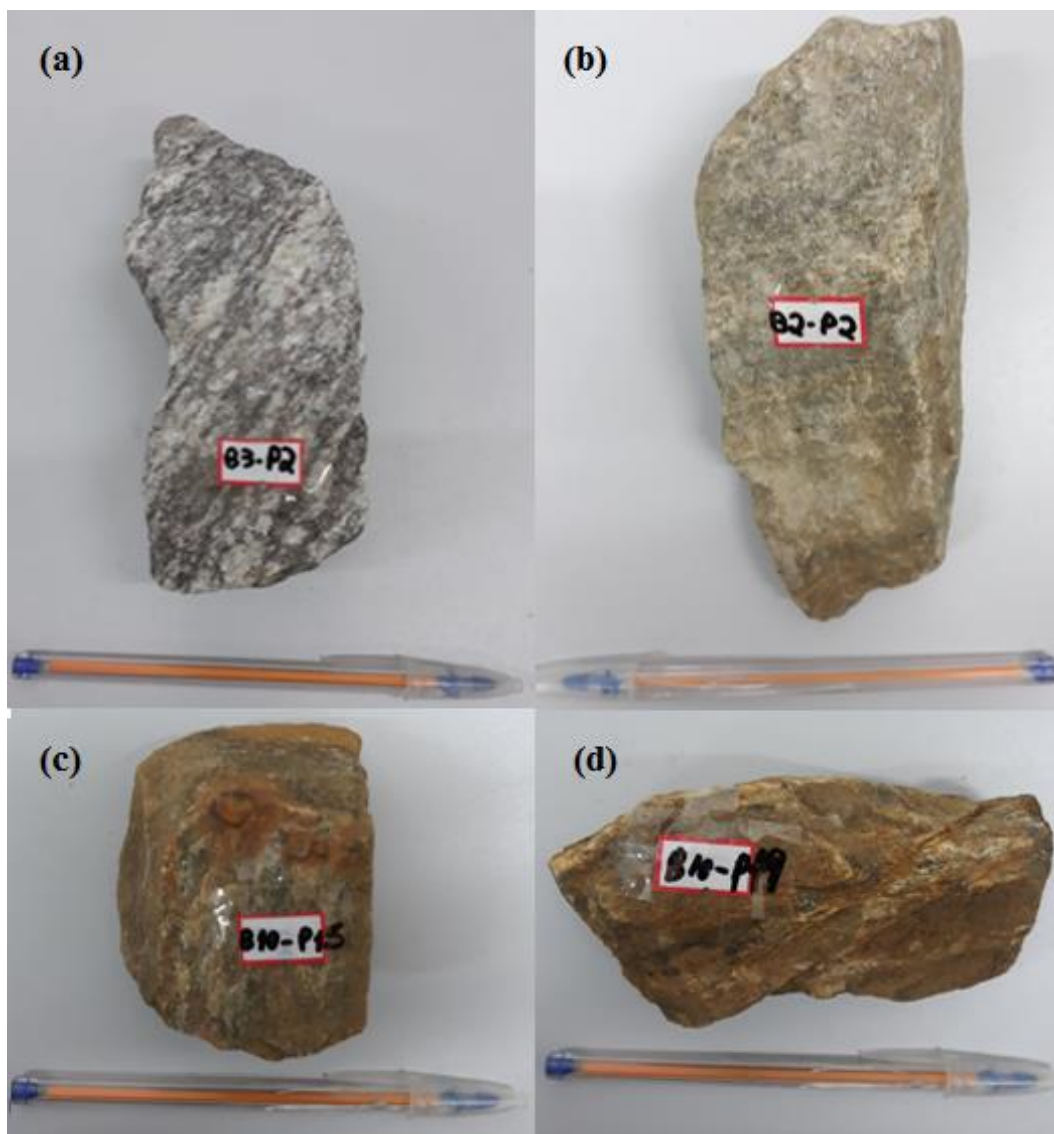
Figura 4.4 – Comparação entre o grau de alteração de amostras classificadas como: (a) rocha inalterada, (b) rocha levemente alterada, (c) e (d) rocha moderadamente alterada.
