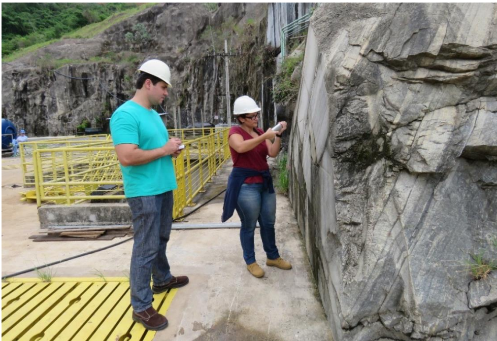
Figura 4.5 – Realização do ensaio de Martelo Schmidt em campo.
