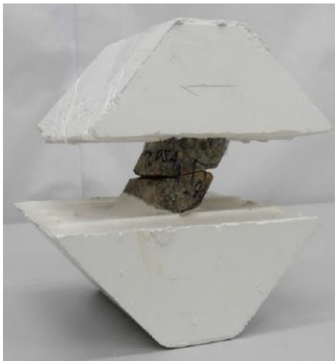
Figura 3.35 – Contato da junta após encapsulamento em moldes de gesso (STEFFENS, 2018).
