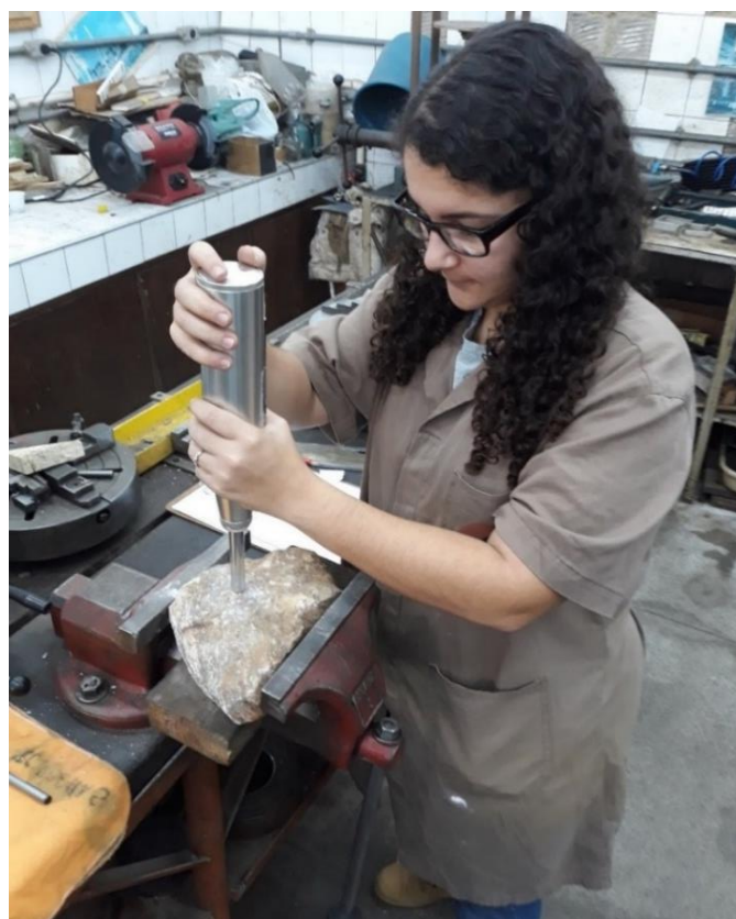
Figura 4.6 – Realização do ensaio de Martelo Schmidt.
