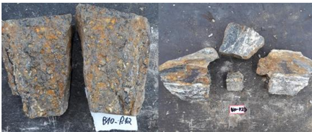
Figura 4.8 – Amostras rompidas durante o ensaio devido à alteração.
