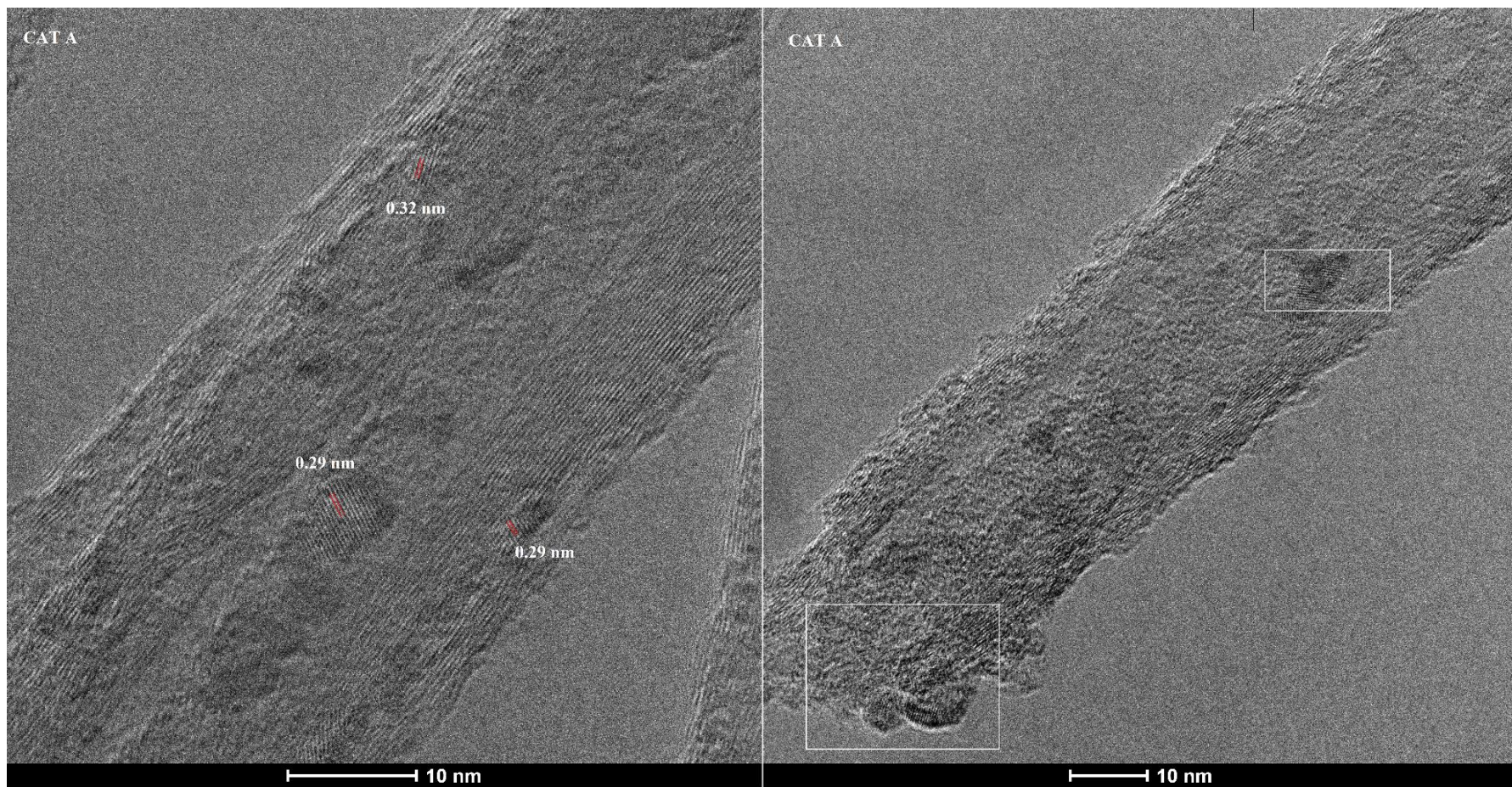
Figura 22 – Microscopia eletrônica de transmissão para o catalisador CAT A, realizada no Núcleo de Microscopia Eletrônica da COPPE.
