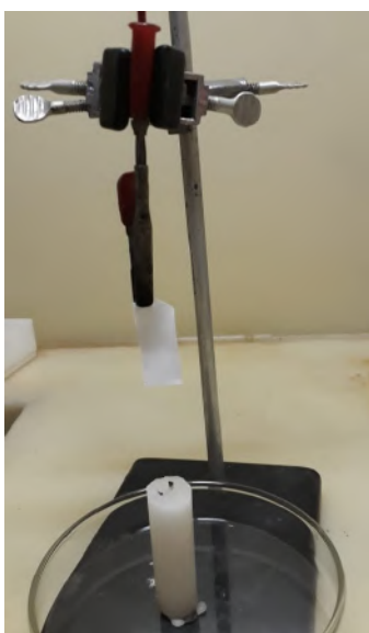
Figura 11. Sistema utilizado para o teste visual de inflamabilidade
