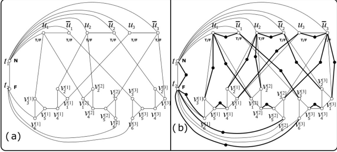
**Figura 2.7:** Instância  $G = (V, E)$  de 3-COLORAÇÃO de [98] em (a) obtida da da instância  $I = (U, C) = (\{u_1, u_2, u_3\}, \{(u_1, u_2, u_3), (u_1, u_2, \bar{u}_3), (\bar{u}_1, \bar{u}_2, \bar{u}_3)\})$  de 3-SAT. (b) O grafo  $G'$  obtido de  $G$  através da adição de um vértice  $x_{uv}$  com  $N_{G'}(x_{uv}) = \{u, v\}$  para toda aresta  $uv$  of  $G$  não pertencente ao triângulo.
