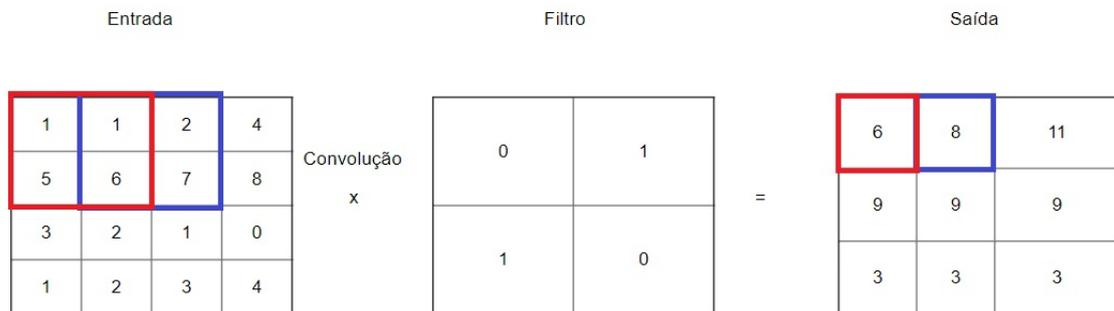
Figura 2.5: Exemplo da execução de uma convolação com filtro 2x2 e *stride* de tamanho 1
