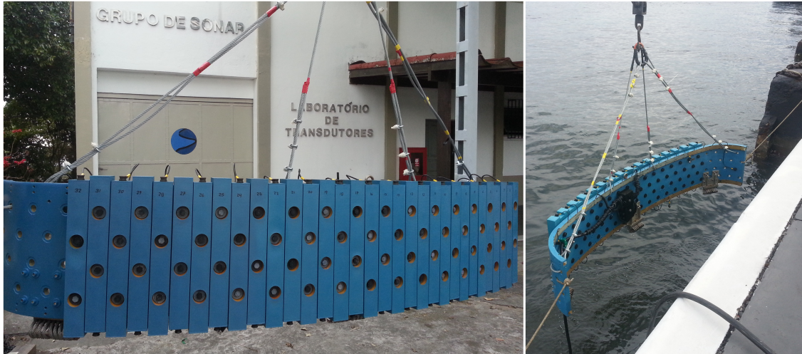
Figura 5.1: VIPP e seu arranjo semi elíptico de staves
