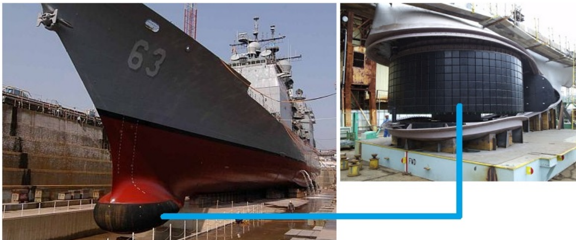
Figura 2.2: Sonar ativo de casco usado em navios para caça de submarinos. Em detalhe, seu arranjo cilíndrico de transdutores.
