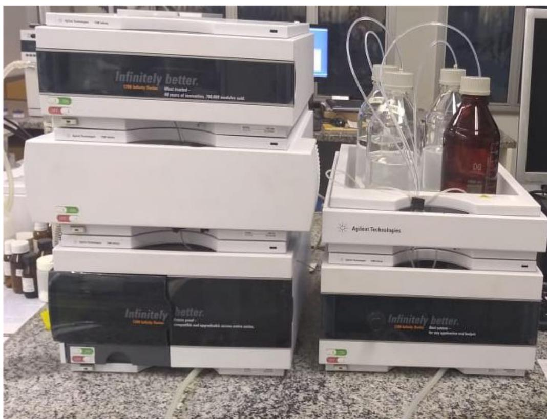
**Figura 12** - Equipamento de cromatografia líquida de alta eficiência (modelo Agilent 1260 Infinity)
