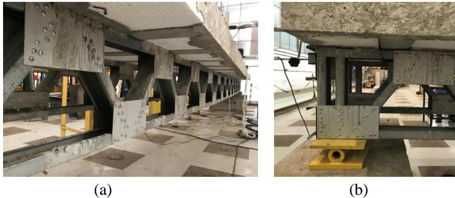
Figura 4.44 – Ligações entre banzos e diagonais através de chapas gusset retangulares e parafusos autoatarraxantes (protótipo TWC): (a) região central e (b) região de extremidade
