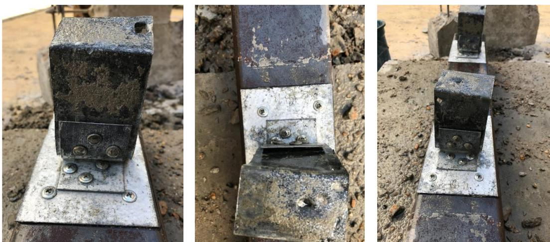
Figura 3.26 – Configuração deformada da cantoneira após a demolição do protótipo
