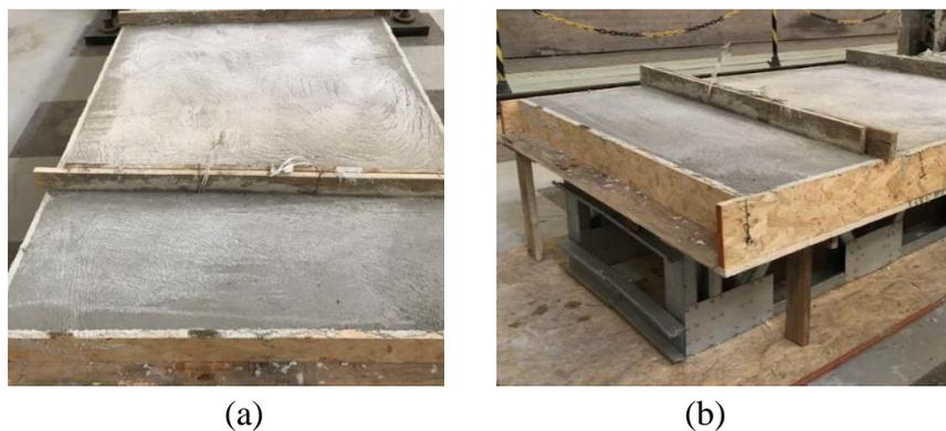
Figura 4.13 – Aspecto da laje 24 horas após a etapa de concretagem do protótipo TWP
