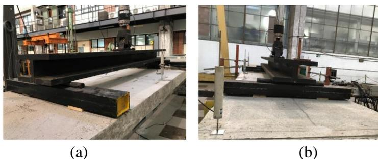
Figura 4.54 – Disposição das vigas de distribuição adotadas para o ensaio do protótipo em escala real, correspondente ao conector TWC
