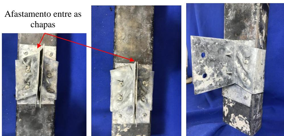
Figura 3.33 – Configuração deformada dos conectores TWP após o colapso do protótipo de *push-out*
