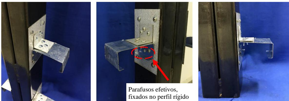
Figura 3.18 – Detalhe de ligação entre o conector TWC e o perfil rígido, adotado para o ensaio de *push-out*
