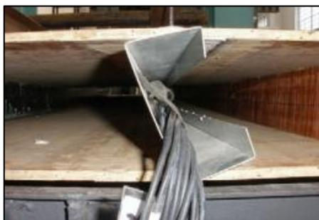
Figura 1.1 – Viga mista composta por perfis formados a frio e painel de bambu
