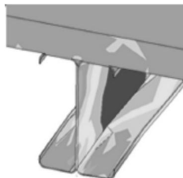
Figura 2.30 – Viga composta por associação entre perfis U enrijecidos com pinos parafusados na mesa superior (FONTE: ALHAJRI *et al*, 2016)
