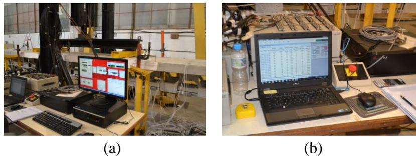
Figura 4.25 – Sistemas de aplicação de carga no atuador hidráulico (MTS) e de aquisição de dados (Kyowa)
