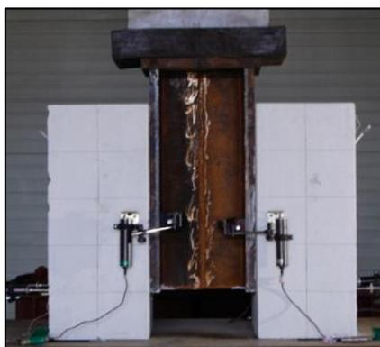
Figura 2.13 – Transdutores de deslocamento dispostos apenas na direção longitudinal (Fonte: KIM *et al*, 2011)
