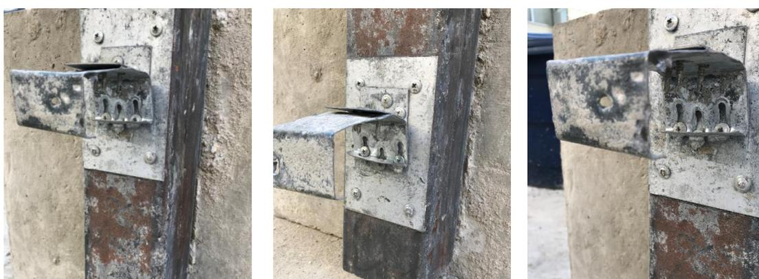
Figura 3.25 – Mecanismo de colapso associado aos conectores TWC nos ensaios de *push-out*
