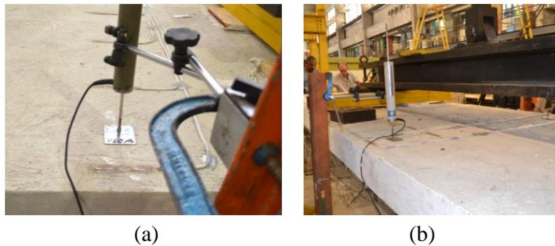
Figura 4.24 – Disposição dos flexímetros em seções intermediária e central (protótipo TWP)
