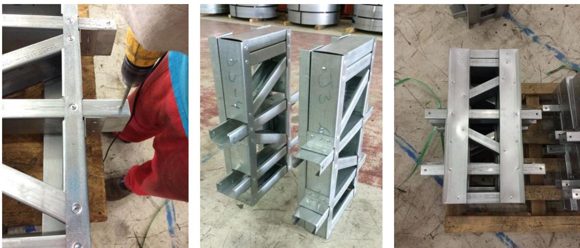
Figura 3.29 – Protótipos destinados ao ensaio (não realizado) de *push-out* dos conectores TWVP
