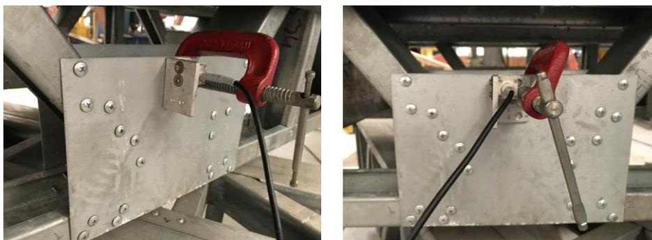
Figura B.1 – Fixação dos acelerômetros nas chapas *gusset* do sistema treliçado
