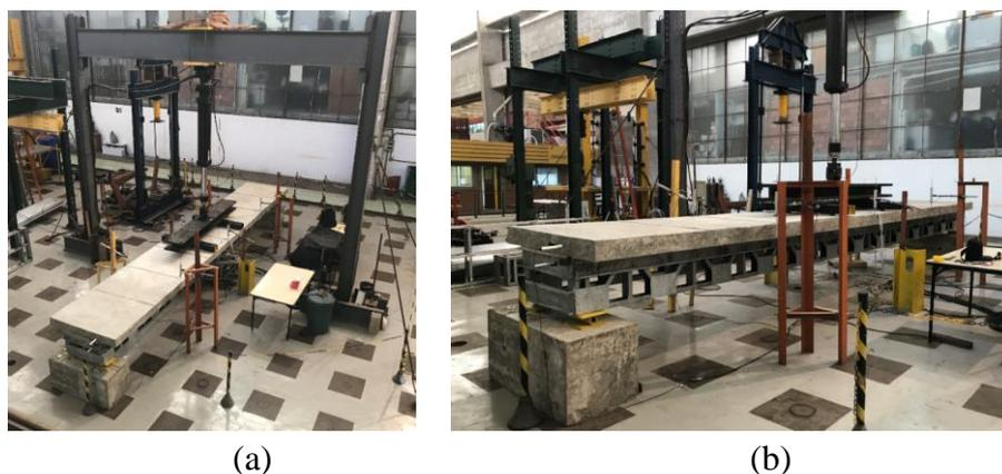
Figura 4.78 – Representação do sistema de introdução de carregamento e da instrumentação adotada para o protótipo TWVP: (a) vista superior e (b) vista lateral
