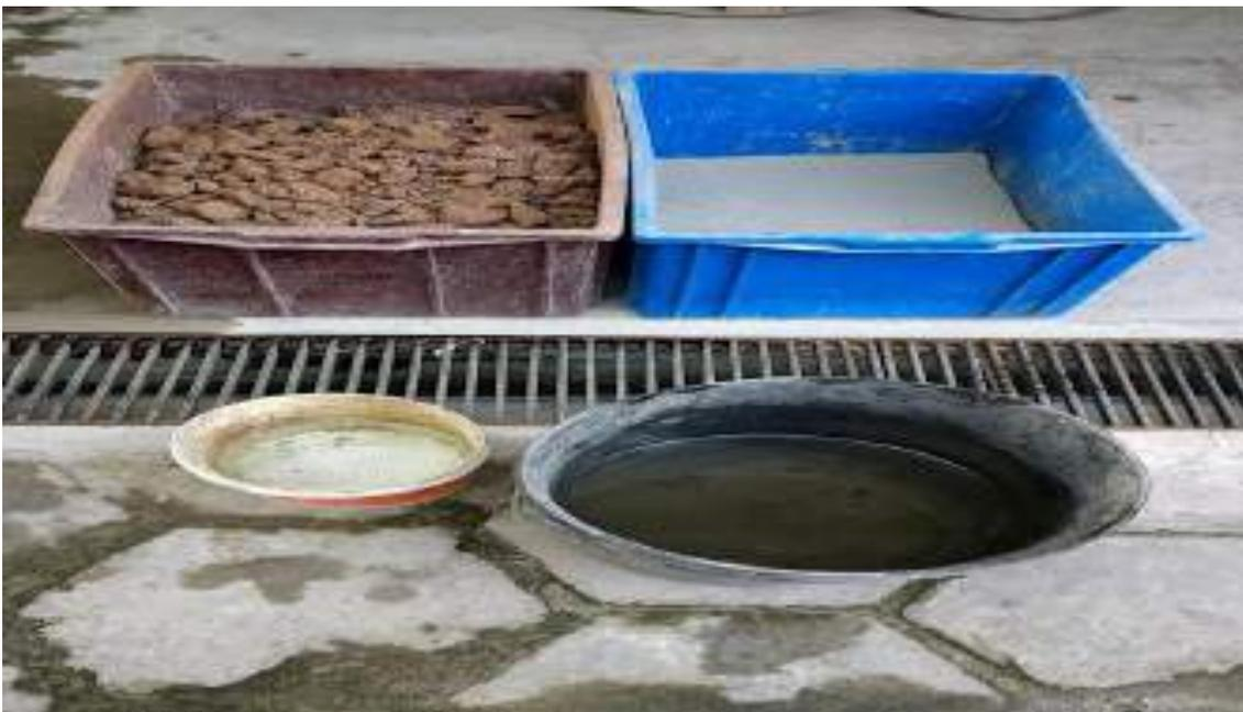
A2.7 - Os materiais, agregado, cimento Portland e água são separados para posterior mistura nas devidas proporções.
