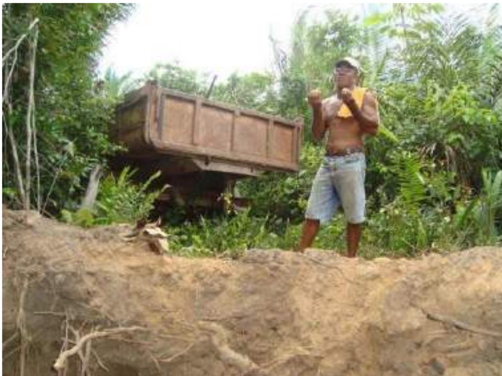
Figura A1.18 - Veículo utilizado no transporte de lateritas, cuja dimensão total é de 6m<sup>3</sup>.
