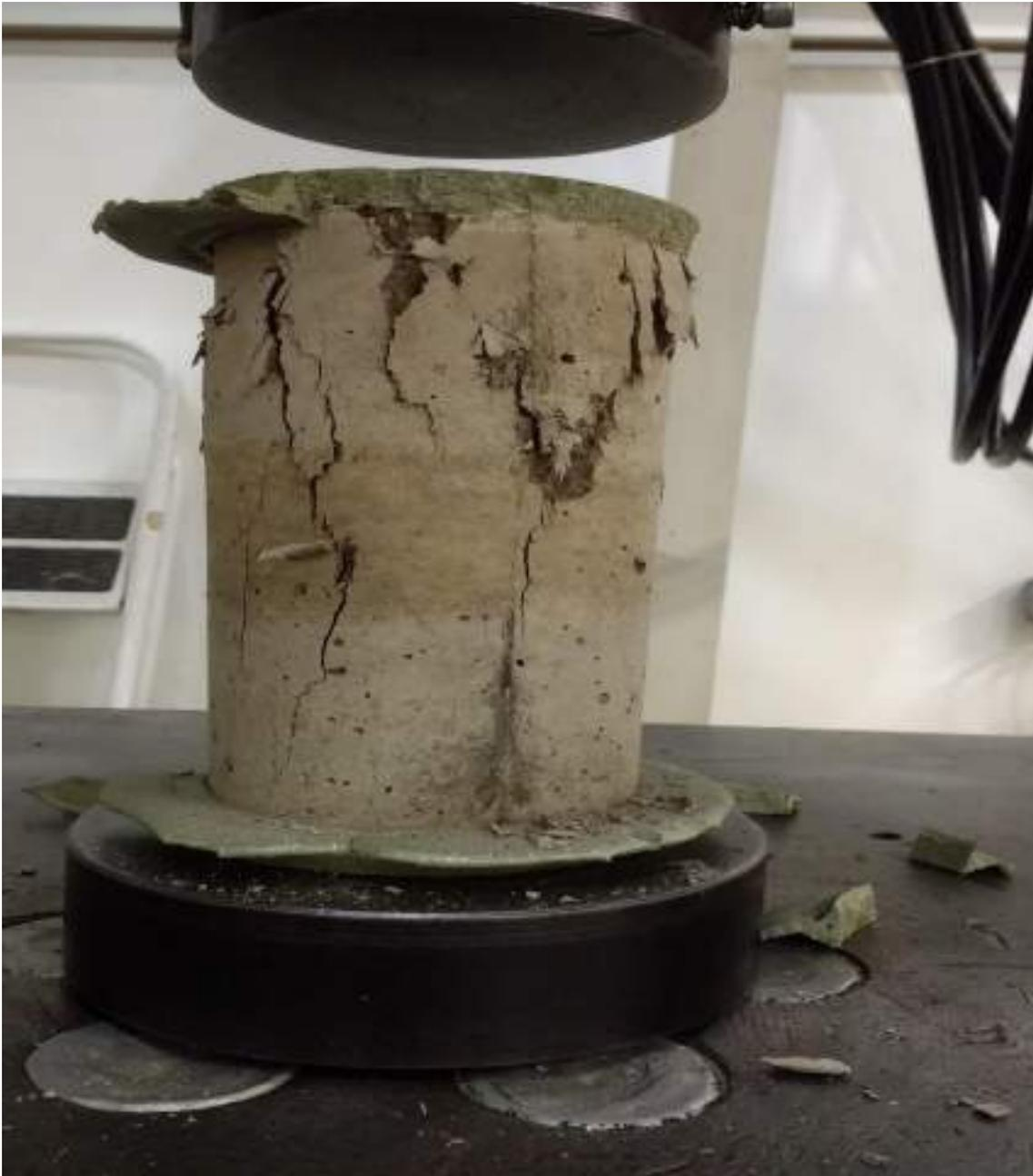
A2.21 - Rompimento do corpo de prova para verificação da resistência máxima a compressão simples. Último estágio do processamento do conglomerado ferruginoso laterítico e que foram levados a prensa hidráulica, conforme demonstra a foto.
