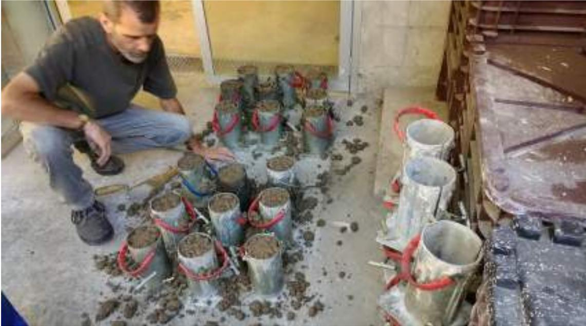
A2.15 - Um grupo de corpos de prova de concreto que foram moldados, que após 24 horas serão desmoldados e levados para a câmara húmida.
