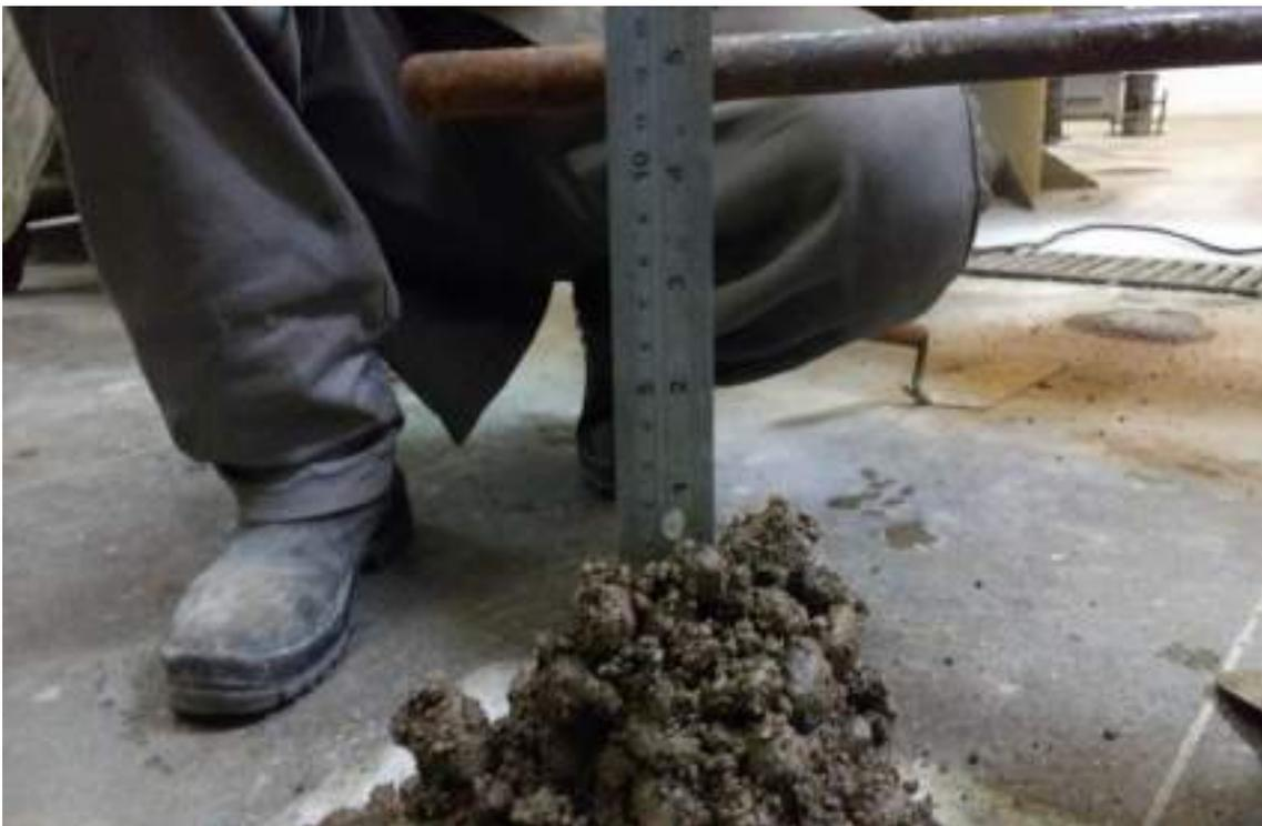
A2.14 - Ensaio de Slump Teste apresentando o abatimento que foi obtido após a desformatação do corpo de prova. Neste caso o concreto apresenta abatimento de mais de 10 cm, quando desformatado, revelando possuir trabalhabilidade. Diferente do concreto apresentado na foto anterior em que permaneceu sem qualquer abatimento.
