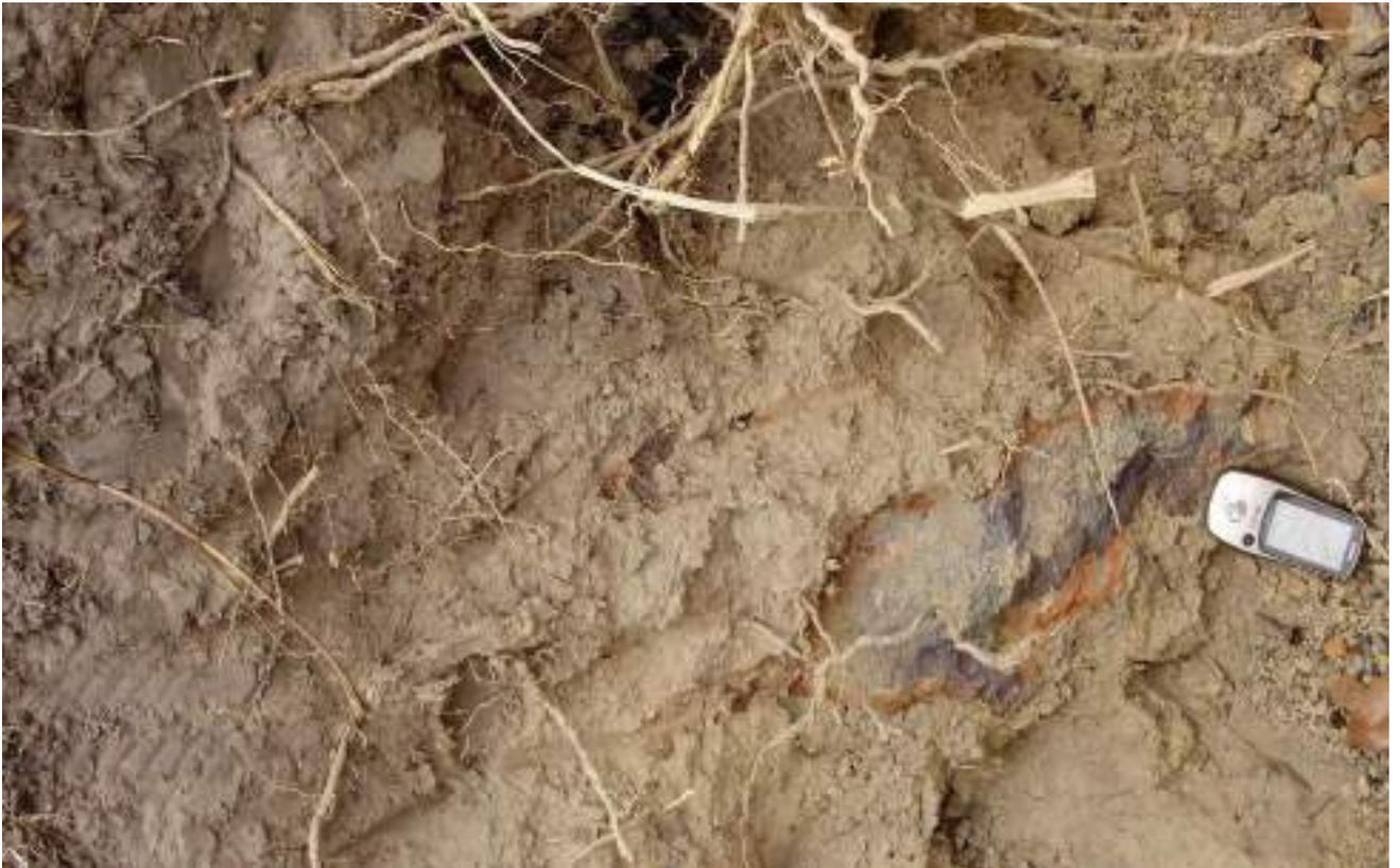
Figura A1.64 - Bloco de conglomerado ferruginoso laterítico marrom dentro da cava.
