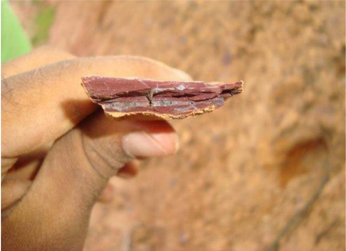
Figura A1.76 - Detalhe da amostra caracterizando uma estratificação do material e com quartzo.
