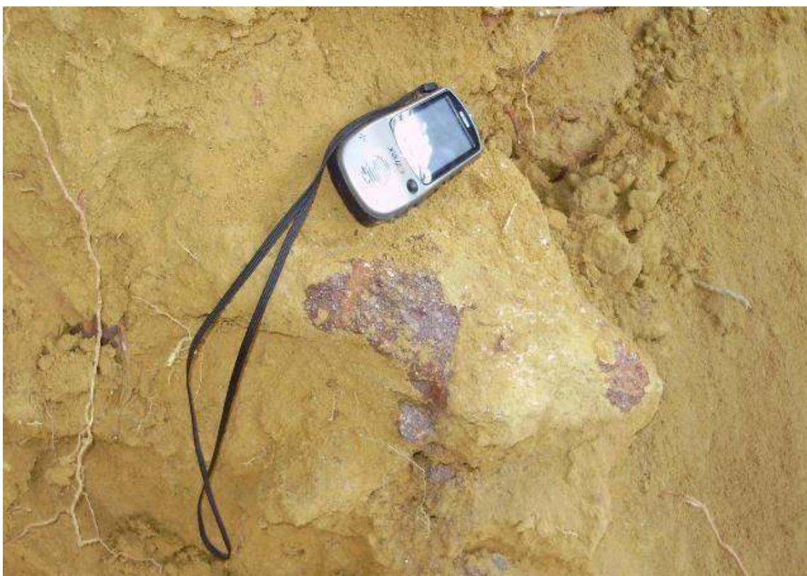
Figura A1.56 - Conglomerado ferruginoso laterítico posicionado dentro da cava.
