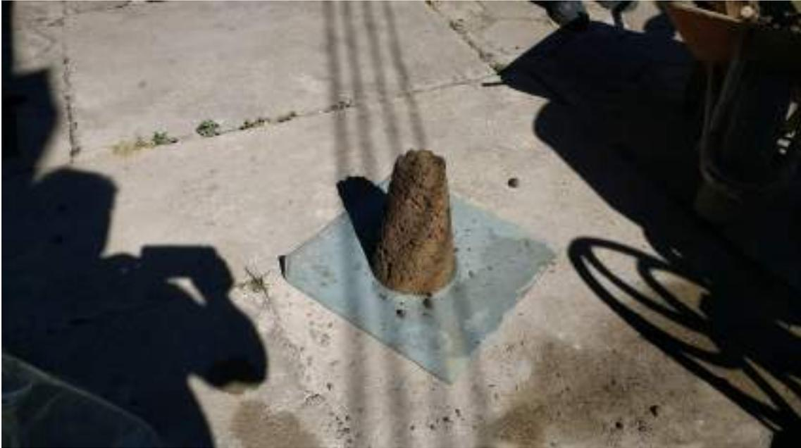
A2.13 - Concreto desformatado da forma de Slump Teste. Notar que o concreto permaneceu com o mesmo formato da forma, significando que o resultado do Slump é praticamente nulo e assim a trabalhabilidade deste concreto é insuficiente. Neste caso fator água cimento deverá ser aumentado.
