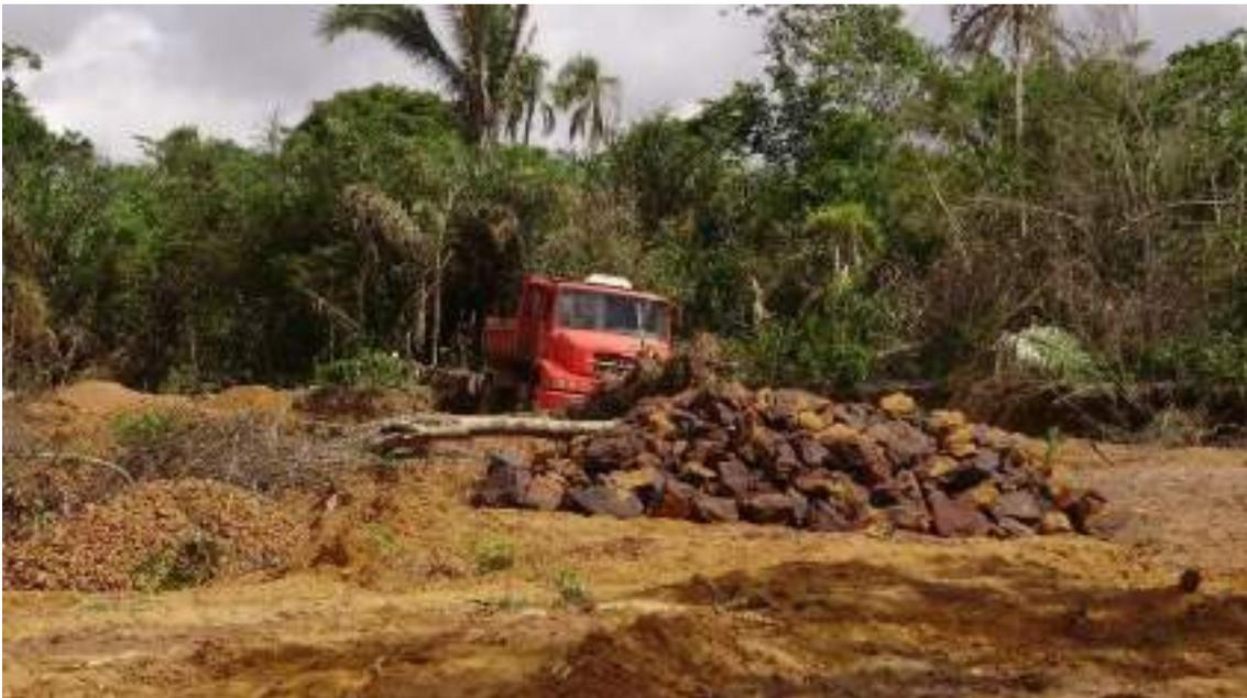
Figura A1.58 - Blocos de conglomerado ferruginoso extraídos aguardando carregamento.
