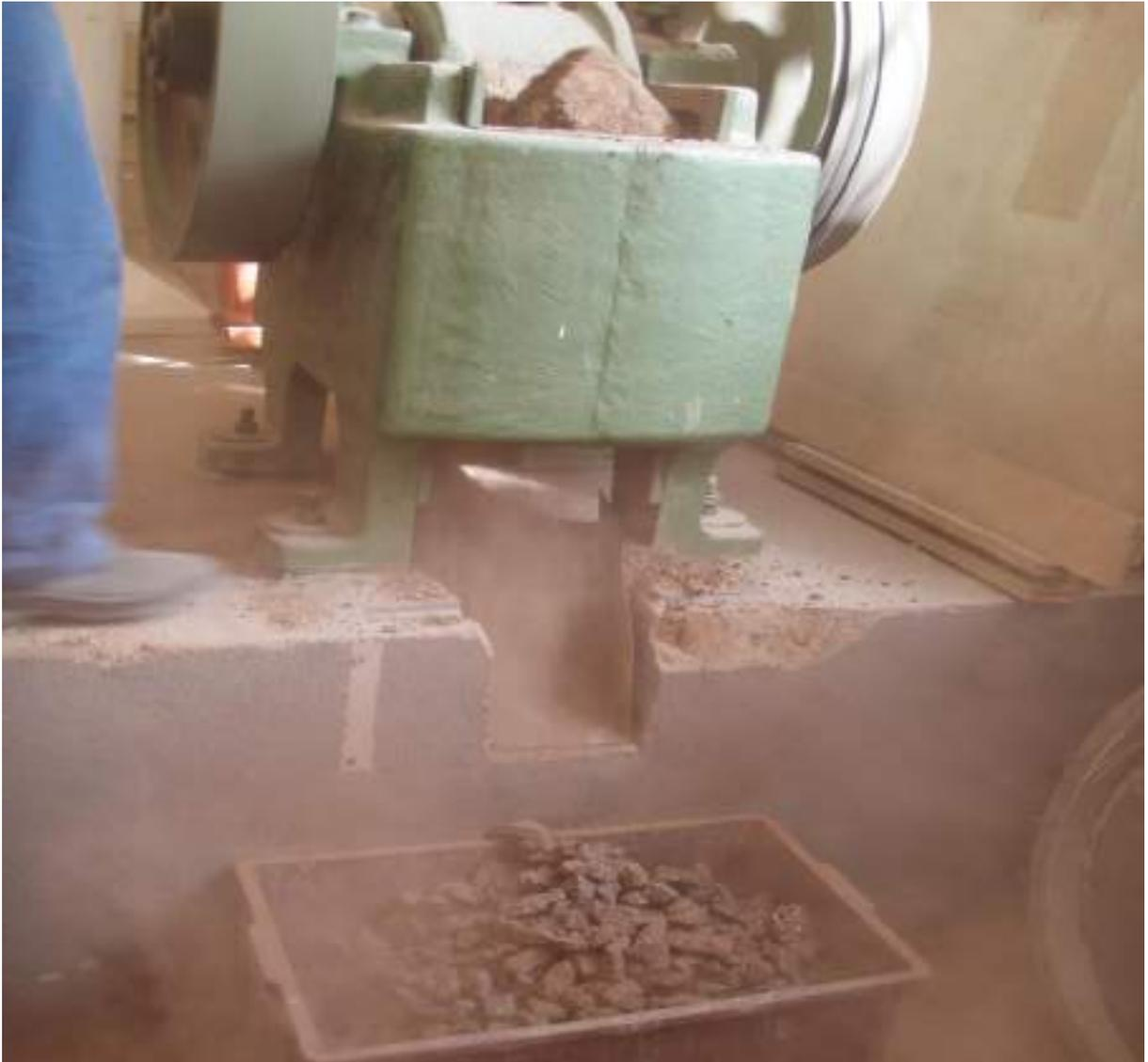
A2.5 - Britador primário utilizado no estudo e com abertura da mandíbula regulado em 2". Foi fabricado pela Briterpa Comercio e Industria Ltda. Modelo BM 13/23, Potência 5/7,5 UP Rotação – 250 a 275 rpm. Observar que o material foi britado e lançado num recipiente de plástico, após que foi juntado a outras porções para quarteamento, que tem a finalidade de melhorar a estatística da amostragem mais bem representada.
