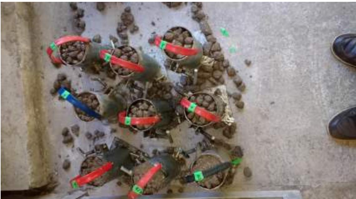
A2.16 - Um detalhe da foto anterior em que evidencia a falta de agregado fino (areia fina média e grossa) entre os agregados graúdos. Estes vazios sem o devido preenchimento promovem uma diminuição da resistência do concreto que foi moldado no corpo de prova.
