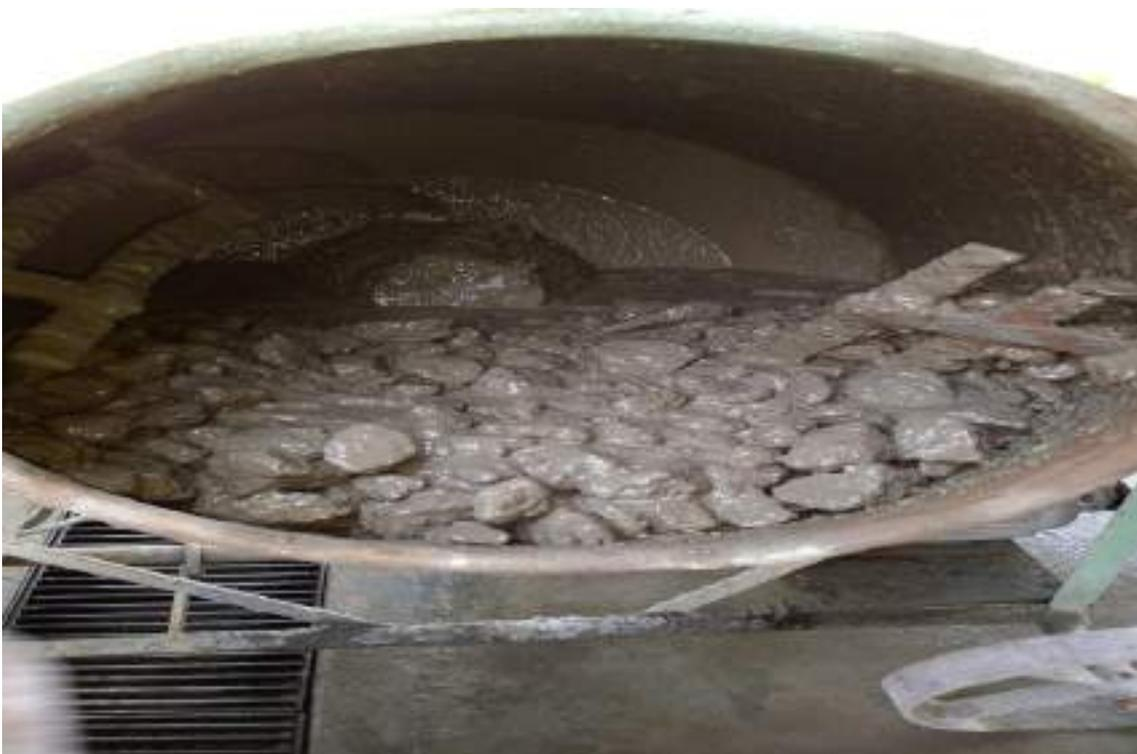
A2.9 - Massa de concreto homogeneizado com agregado, cimento e agua nas devidas proporções para posterior moldagem nos corpos de prova e cura na câmara húmida, após que serão rompidas na prensa hidráulica para verificação da resistência a compressão simples em MegaPascal
