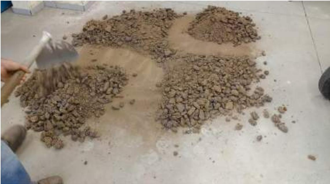
A2.6 - O material depois de bitado é quarteado e separado para uso na elaboração do concreto e assim abrindo oportunidade para os cálculos dos traços e fatores água cimento
