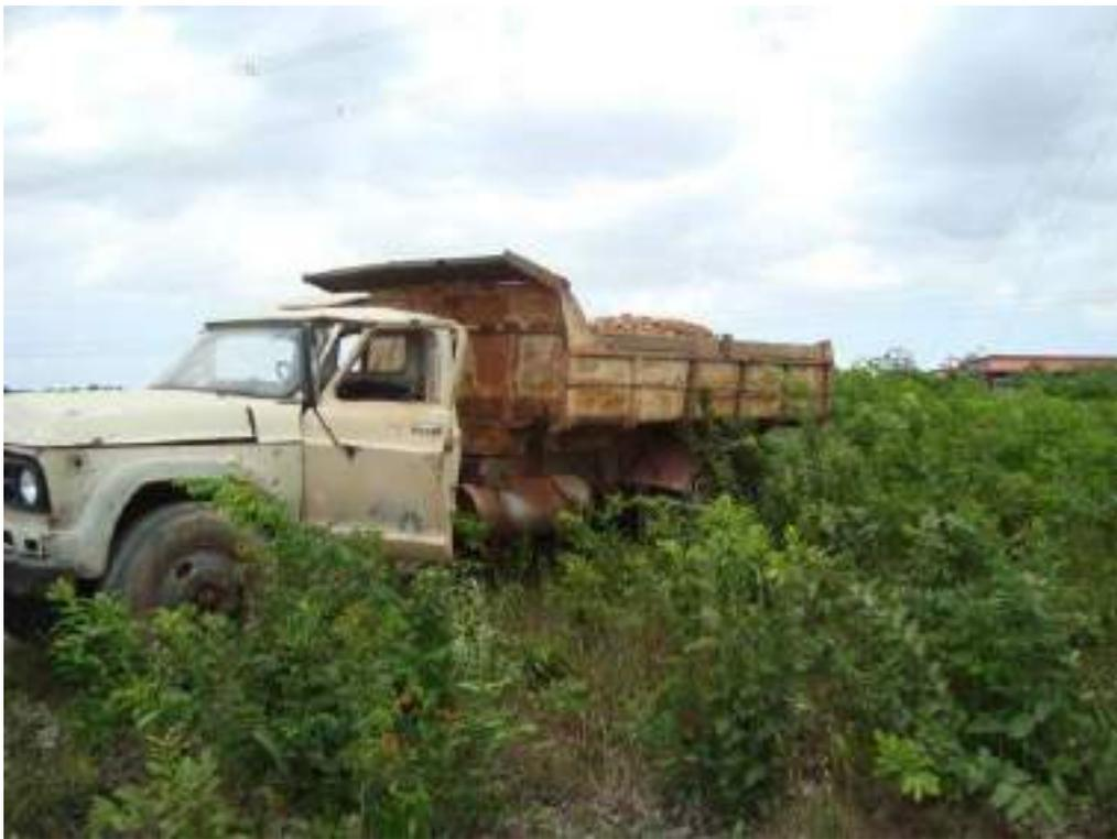
Figura A1.21 - Caminhão basculante, capacidade de 6m<sup>3</sup> utilizado no transporte de lateritas.
