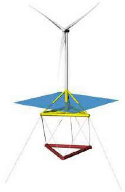
Figura 1-11: Unidade Flutuante, conceito Tetraspar. Fonte: STIESDAL (2019).
