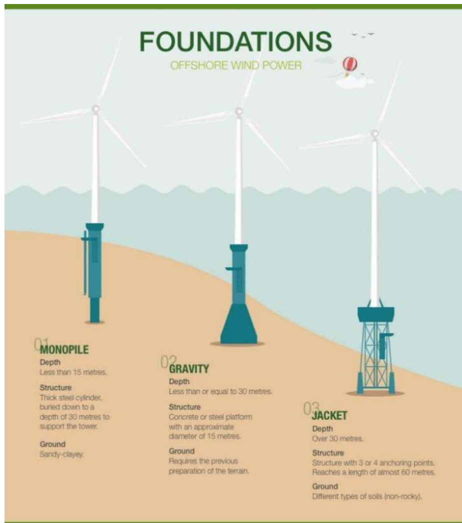
Figura 1-6: Fundações Fixas. Fonte: Iberdrola (2019).
