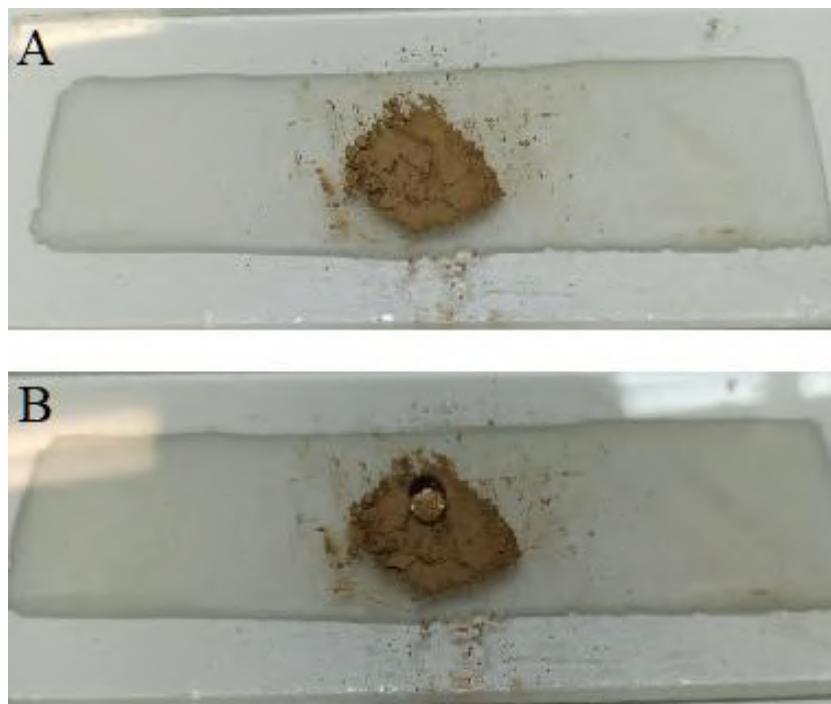
Figura 18: Teste de hidrofobicidade da lignina tratada com \text{SF}_6 . A: Disposição da lignina seca; B: Lignina após aplicação de uma gota de água.
