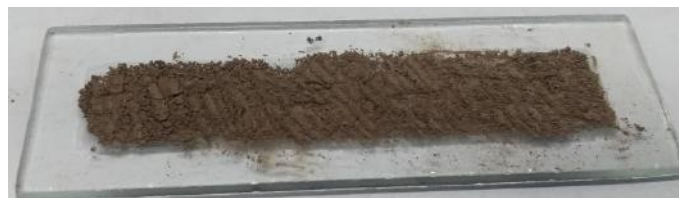
Figura 15: Placa de vidro com camada de lignina pronta para aplicação do plasma.
