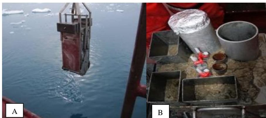
Figura 6 | Amostragem com Box-corer na Baía do Almirantado. A. Içamento do Box-corer e B. Repartição dos testemunhos dentro do Box-corer. Fotos: Adriana G. Dalto, retiradas do Relatório Sucinto de Campo da 4ª fase de pesquisa da Operação Antártica XXVIII (2010/2011).
