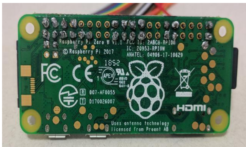
Figura 37 – Portas GPIO do Raspberry Pi soldadas
