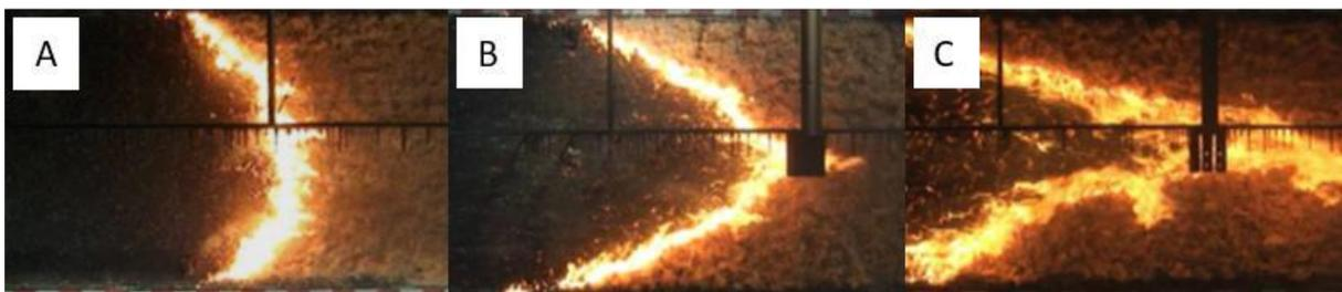
Figura 7. Padrão de propagação da frente da chama a) em relevo plano, b) em encosta com 20° de declive e c) em encosta com 30° de declive. Fonte: Adaptado de Silvani *et al.* (2012).
