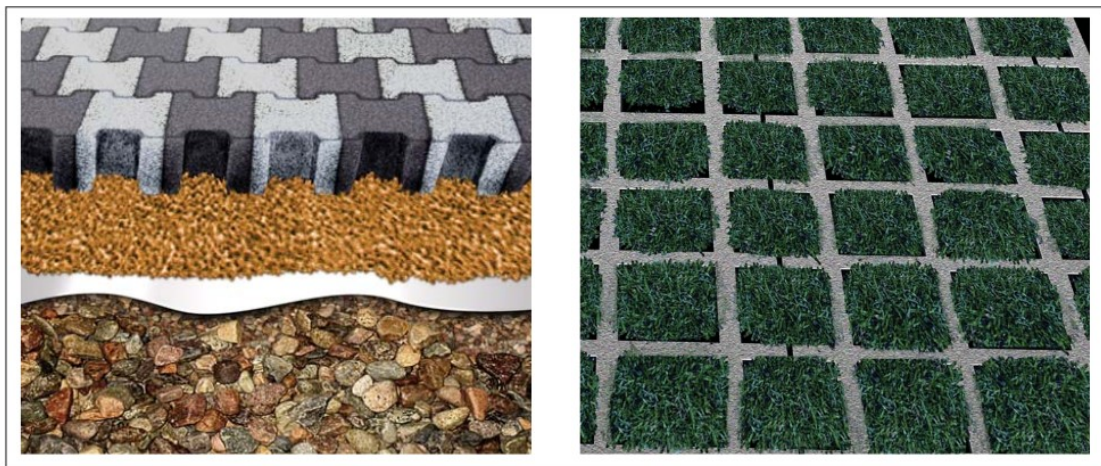
Figura 3.7: Exemplo de piso permeável. Na esquerda piso intertravado e a direita “concreto-grama” (CAIXA, 2010)
