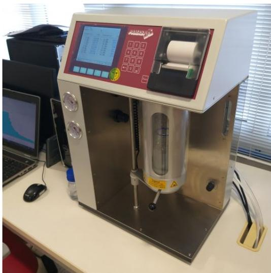
Figura 5.9: Imagem ilustrativa do contador adquirido. Fonte: PAMAS.
