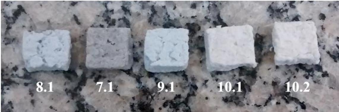
Figura 8 – Amostras de diferentes colorações em função de suas composições e do papel utilizado na mistura.
