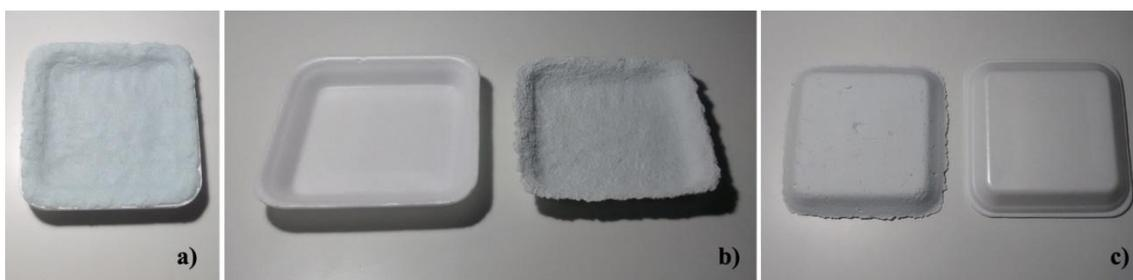
Figura 16 – Polpa úmida moldada em forma de EPS (a); Molde de EPS e bandeja pronta após secagem (b e c).
