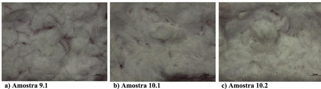
Figura 11 – Microscopia das amostras 9.1, 9.101 e 9.102 indicando a variação do teor de amido na composição.
