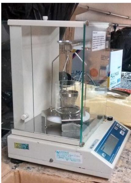
Figura 7 – Montagem do experimento para determinação da porosidade e densidade aparente.
