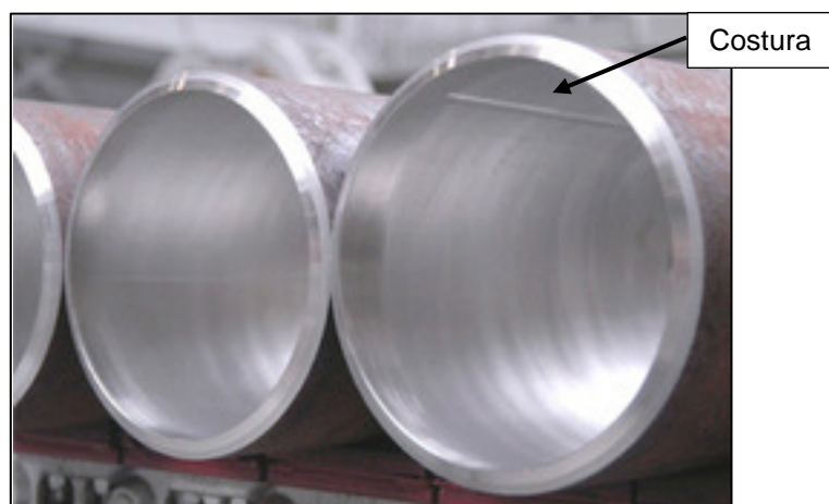
Figura 4 – Tubo com costura cladado, no qual é possível observar a solda longitudinal realizada [5].
