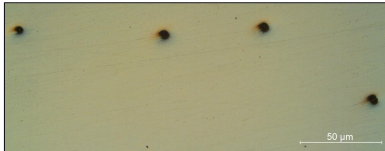
Figura 37 – Aspecto micrográfico sem ataque da superfície polida do corpo de prova apresentando porosidade resultante do procedimento de soldagem. Ampliação 500x.
