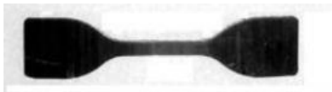
Figura 16. Corpo de prova em formato “halterê” para ensaio de tração Ramos, 2013
