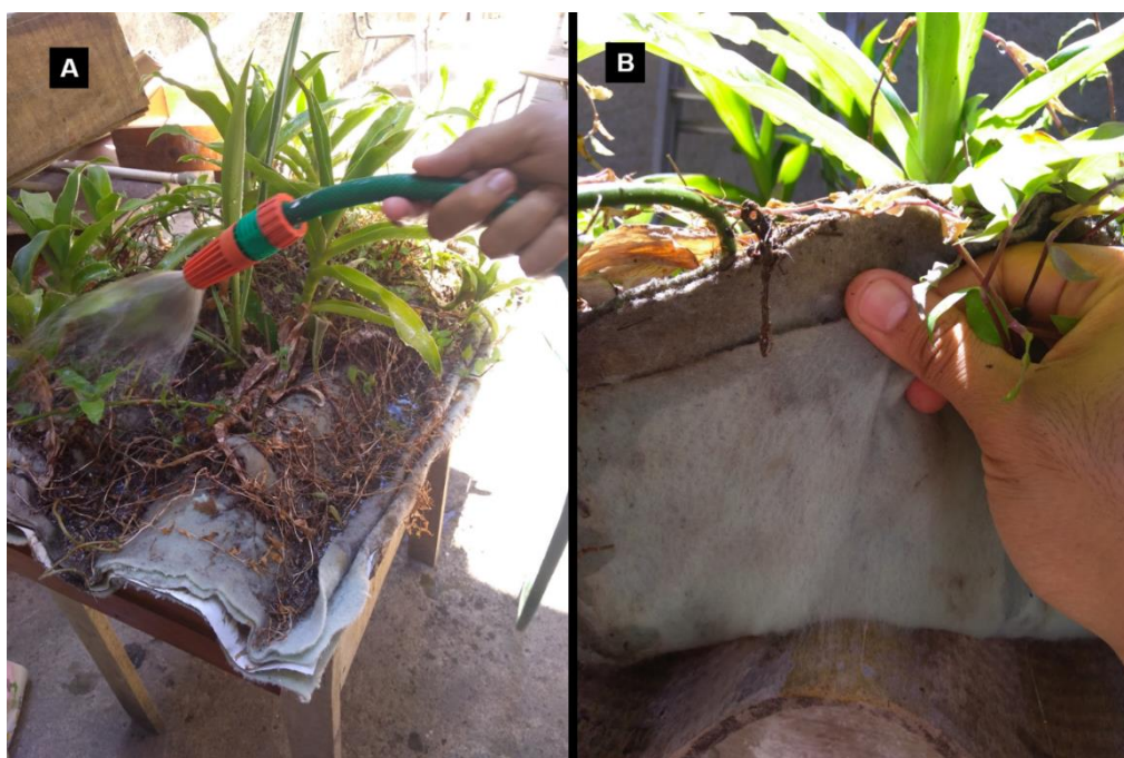
Figura 20. Verificação da estanqueidade do sistema pela: a) Irrigação do protótipo; e b) verificação da estanqueidade sob o banner
