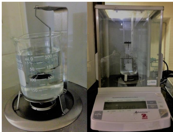
Figura 23. Equipamento para ensaio de densidade com base na ASTM D792
