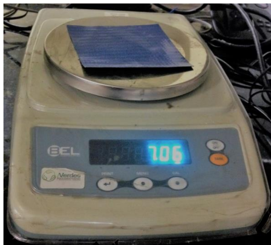
Figura 21. Ensaio de gramatura em lona de PVC
