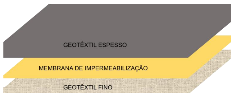
Figura 4. Sistema hidropônico de telhado verde composto por três camadas segundo Rezende (2013)
