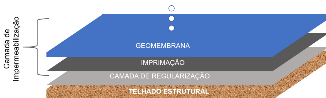
Figura 5. Disposição da camada de impermeabilização composta por imprimação e manta de impermeabilização segundo Gatto (2012)
